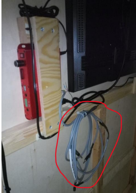
Abbildung 29: der Mediaplayer MP01 und das Kabel zum Anschließen der Taster
