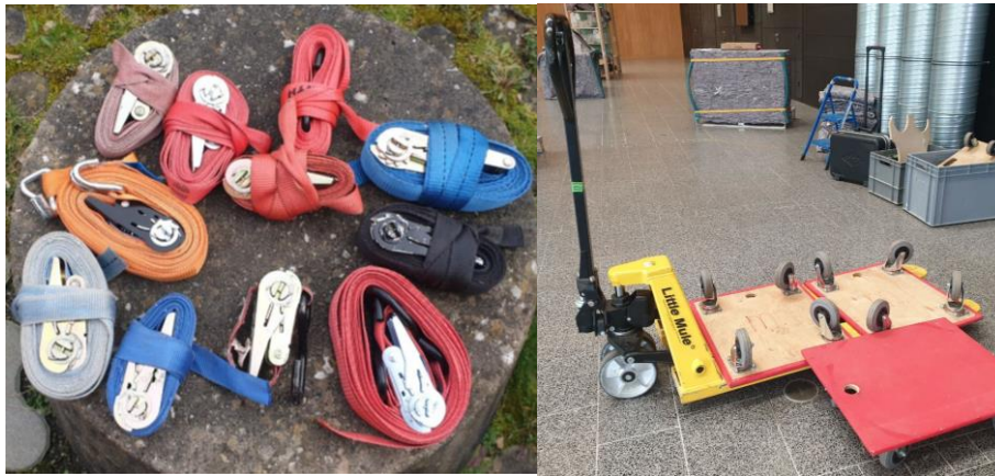
Abbildung 61: Zusätzliche Spanngurte zur Ladungssicherung und Rollbretter und Hubwagen für den Transport zum Ausstellungsort
