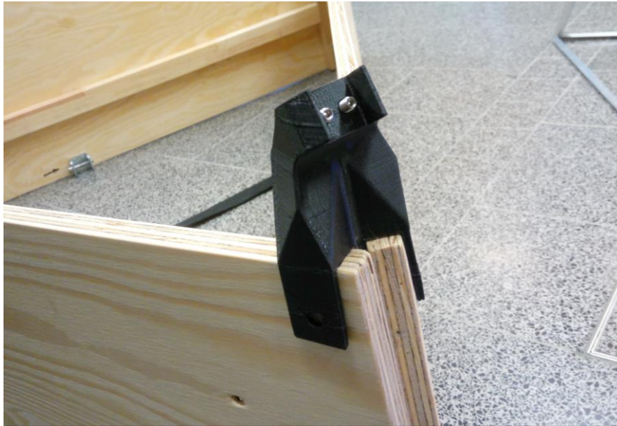
Abbildung 32: Die Verbinder des Sockels mit dem Aluminiumrahmen
