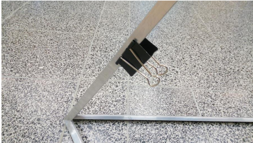
Abbildung 34: Klammern (Foldback Clip) zum Verbinden der drei Rahmenelemente
