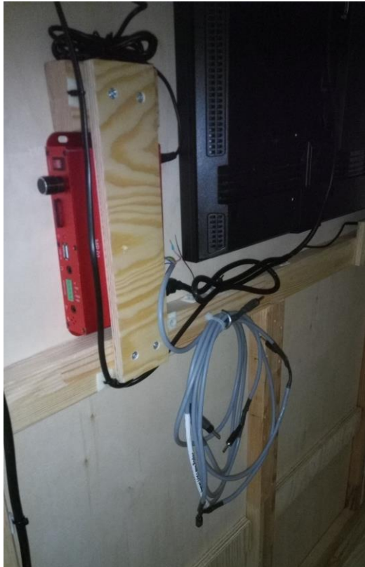
Abbildung 67: Beim Transport wird das Tasterkabel aufgerollt an den Haken gehängt
