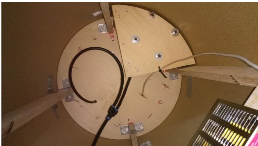
Abbildung 41: Verschraubung des Druckzylinders (Pumpe) der Interaktion Druckluft, in der Papptonne der Interaktion
