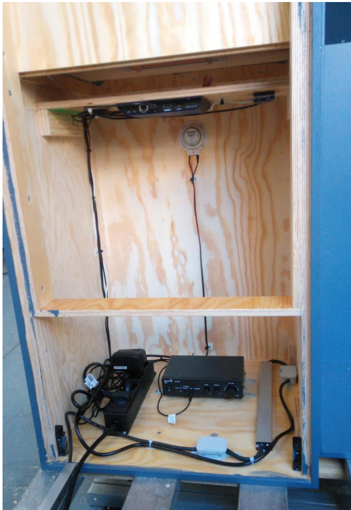
Abbildung 16: Geöffnete Revision der Kasse. Mediaplayer, Verstärker, RFID Technik und Beleuchtung der Scannfläche
