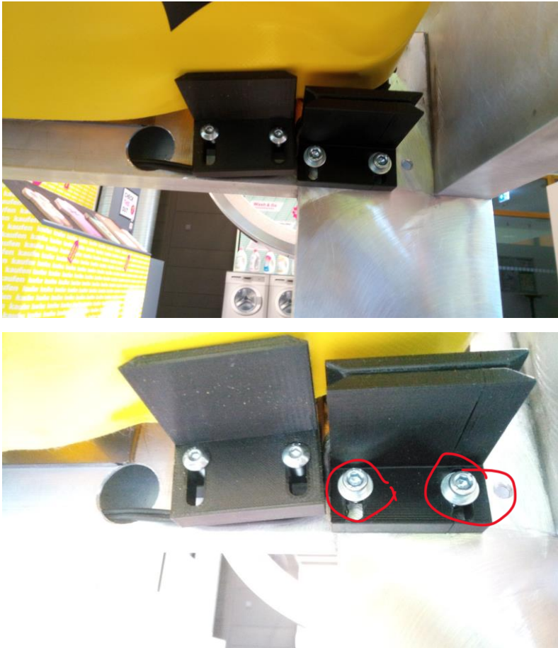
Abbildung 8: Einstellung der Position der Lichtschraken
