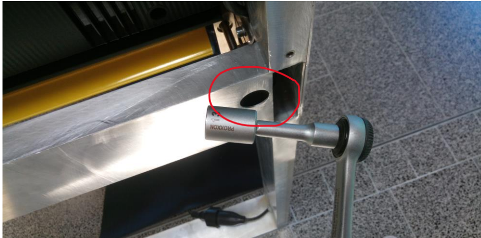
Abbildung 4: Lösen und Spannen der Plane mit Nuss (SW13)
