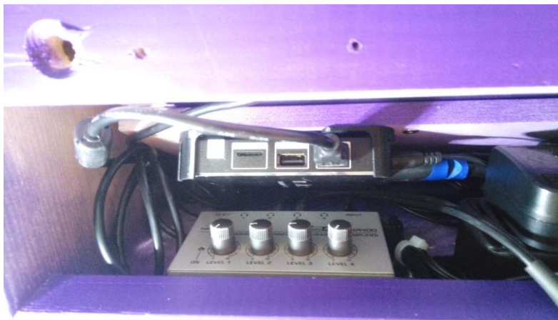
Abbildung 55: 4k Light Mediaplayer und Verstärker der Kopfhörer.
