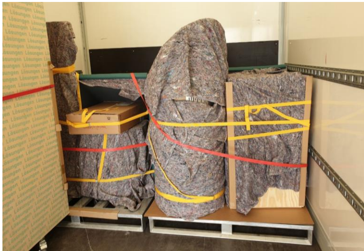
Abbildung 64: Verpackte Stationen mit Packdecken, Kantenschutzprofilen und Spanngurten (gelb)
