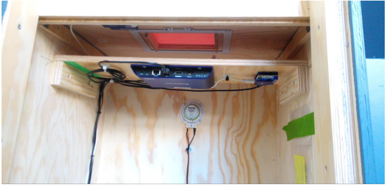
Abbildung 17: Mediaplayer BrightSign und RFID Technik
