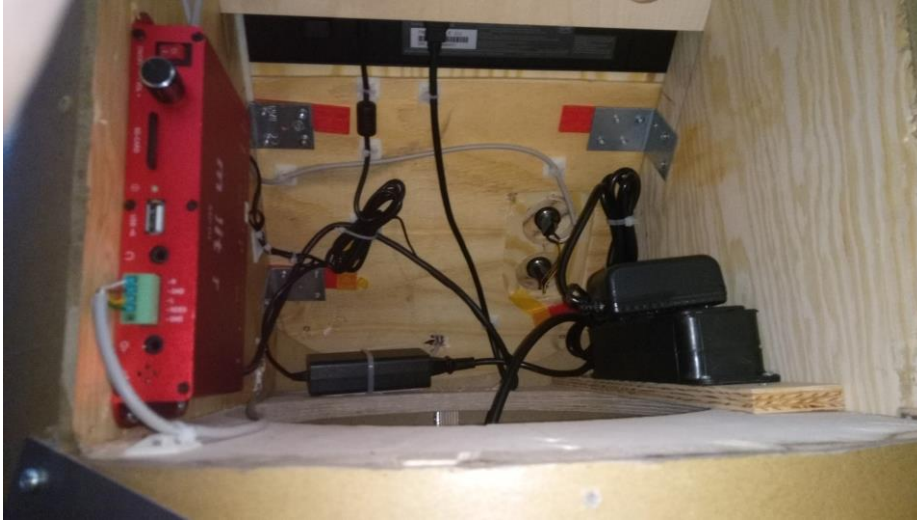
Abbildung 38: Verkabelung der Medienstele. Mediaplayer MP01
