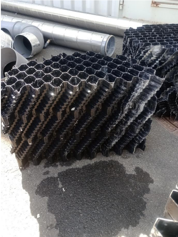
Abbildung 14: Ablagerung auf benutzter Füllkörperpackung (rohgasseitige Packung)
