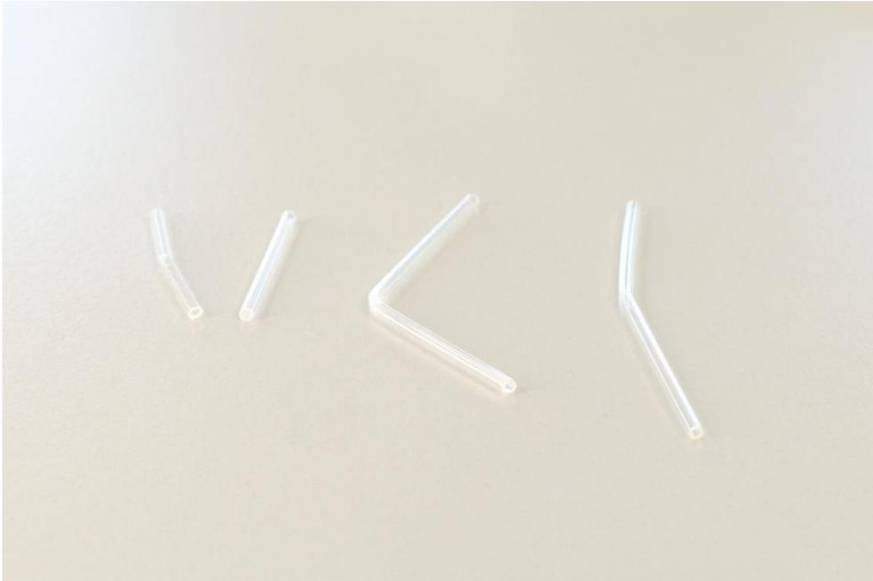
**Abbildung 2: Modifikation von PLA (links) mit einem Weichmacher (Mitte) und dem Copolymer (rechts). Unmodifiziertes PLA weist eine geringe Bruchdehnung. Sowohl Weichmacher als auch Copolymer ermöglichen Dehnung von 100% mit dem höchsten Rückstellvermögen beim Copolymer modifiziertem PLA.**
