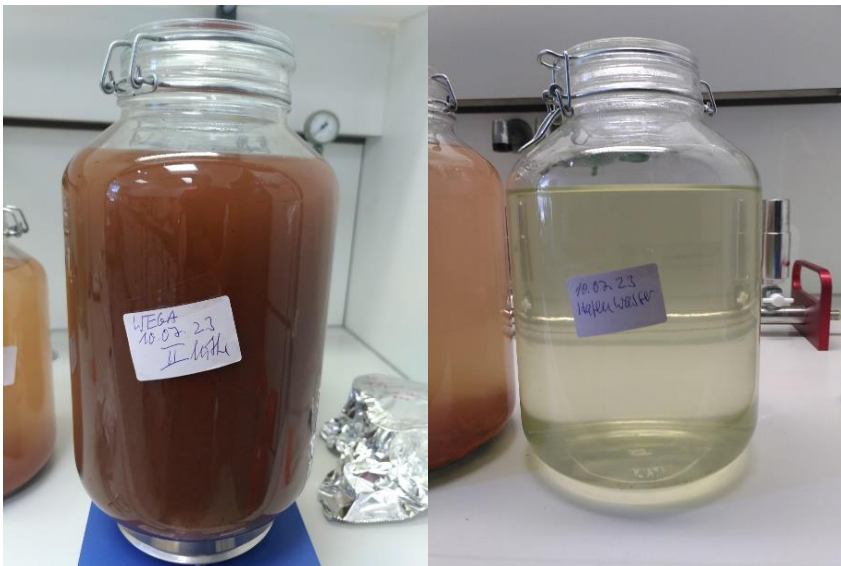
Abb. 2: Links Abgesaugtes Wasser aus der Abreinigung der „WEGA“, rechts Hafenwasser entnommen vor der Reinigung
