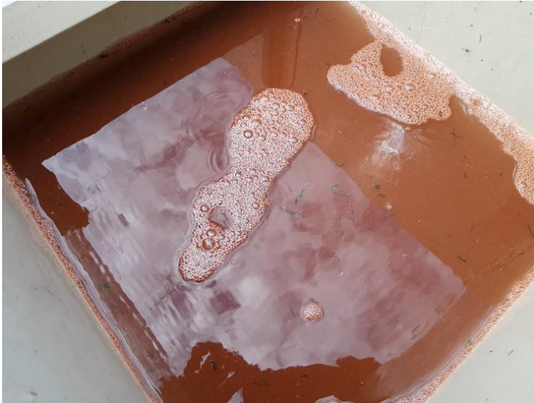
Abb. 1: Abgesaugtes Wasser nach Abreinigung der biozidhaltigen, weichen Antifouling auf der „WEGA“
