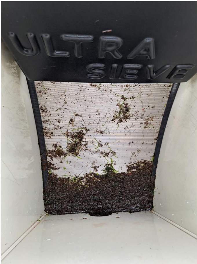
Abb. 8: Im Feinsieb aufgefangener Bewuchs/Biofilm
