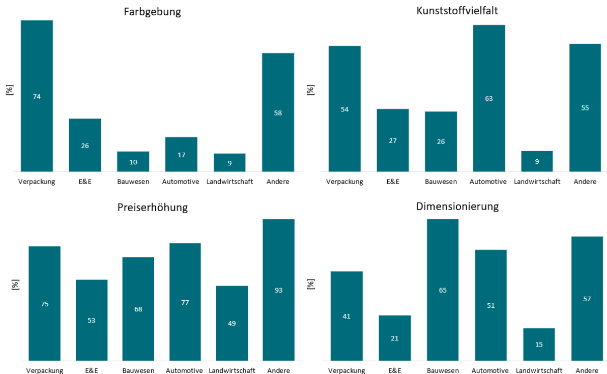
Abbildung 4-29: Prozentuelle Steigerung der zulieferbaren Rezyklatmenge je Branche in Abhängigkeit der Anforderungsänderungen bezogen auf die Gesamttonnage
