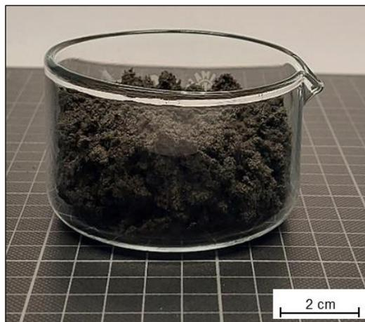
**Abbildung 4:** Schleifspäne des Werkstoffs X153CrMoV12 im Anlieferungszustand.
