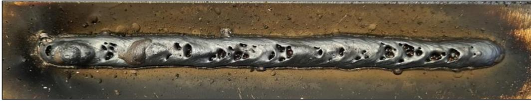
**Abbildung 35:** Makroskopische Aufnahme der Probeschweißung des mit Schleifspänen adaptierten Fülldrahts nach der durchgeführten Wärmebehandlung bei 220 °C.
