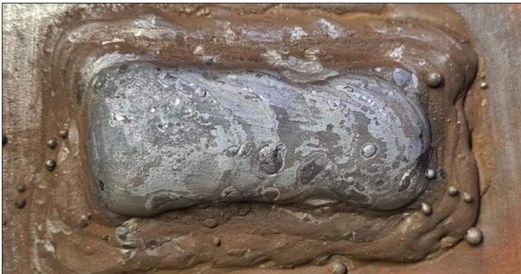
**Abbildung 36:** Makroskopische Aufnahme der sechslagigen Probeschweißung des mit Schleifspänen adaptierten Fülldrahts nach der durchgeführten Wärmebehandlung bei 350 °C.
