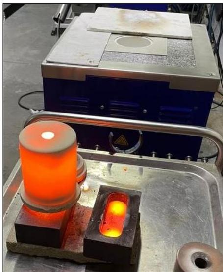
**Abbildung 12:** Aufnahme der glühenden umgeschmolzenen Bramme aus der Schleifschlammfraktion  $<45\ \mu\text{m}$  mittels des Induktionsumschmelzofen MU700 der Fa. Indutherm.
