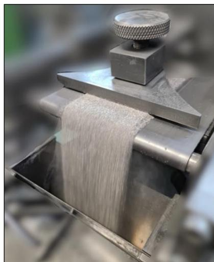
**Abbildung 34:** Darstellung eines Teilprozesses der Fülldrahtfertigung. Zu sehen ist eine Dosiereinheit und ein Trichter zum Befüllen des Fülldrahts.
