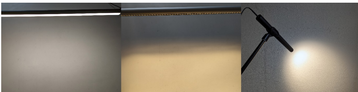
Abbildung 15: Lichtarten in 3 Modulen: linear diffus, linear gerichtet, Punktlichtquelle
