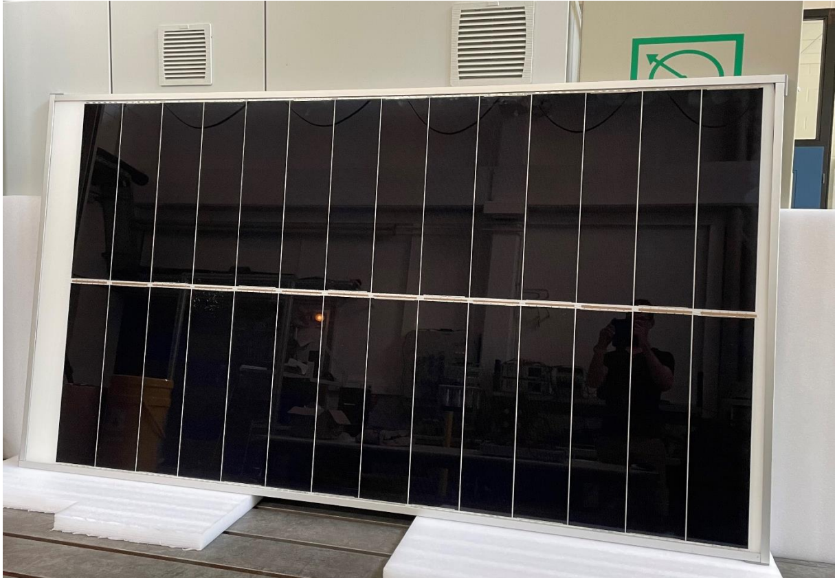
Abbildung 1.1: Foto des ersten Modells des AC Solar-Moduls für kostengünstige und standortunabhängige Installation
