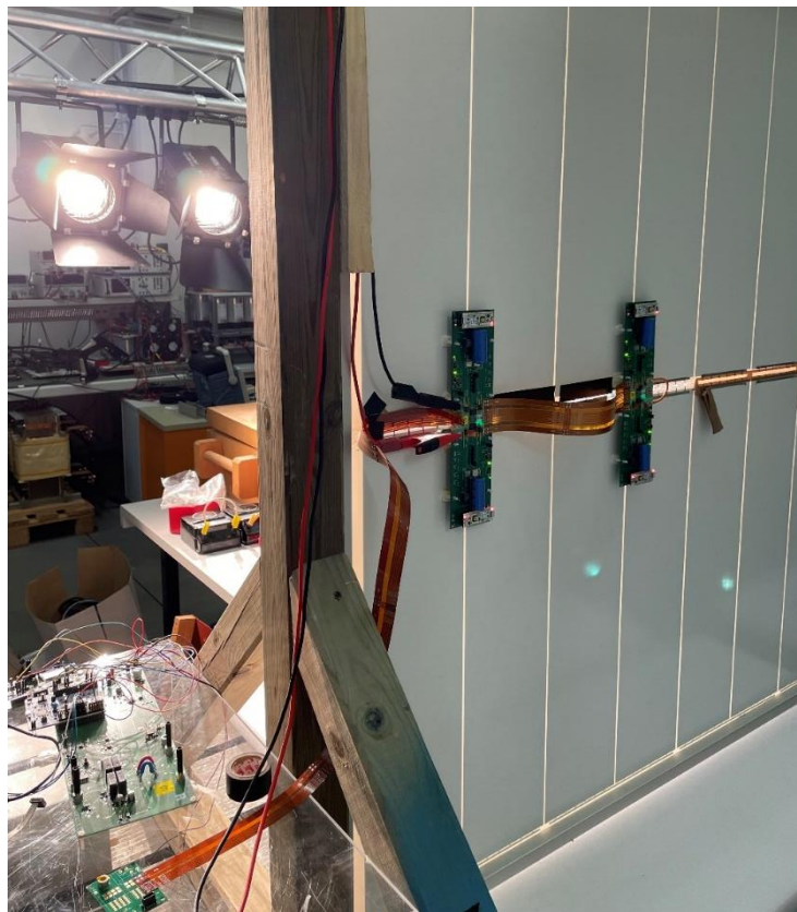
Abbildung 7.3: Foto vom Versuchsaufbau des Verschattungstest mit Beleuchtung und Elektronik
