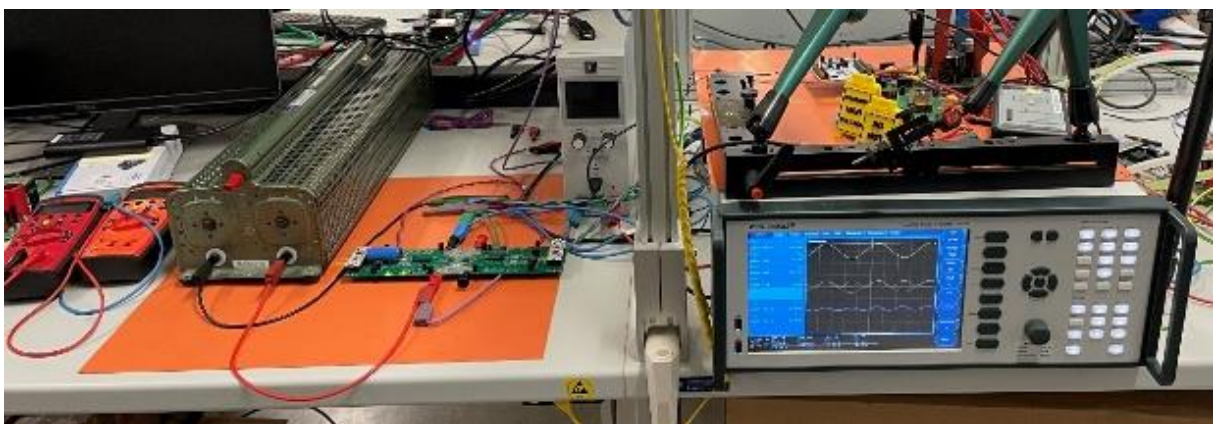
Abbildung 6.1: Foto von der AC-Effizienzmessung der PowerUnit am IAL
