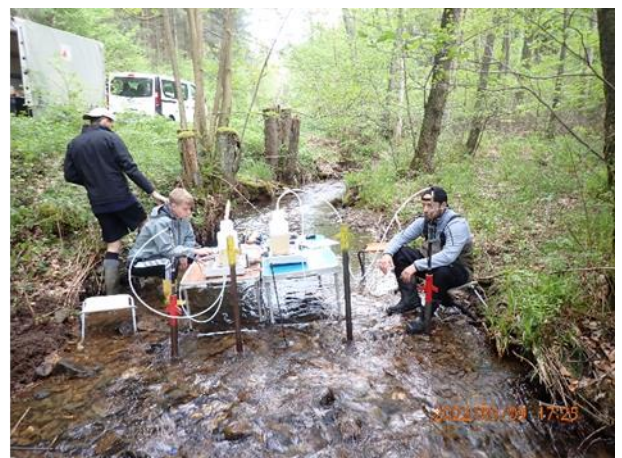
Abbildung 2-6-: Datenerfassung und Equipment zur Messung der vertikalen Profile von hydraulischen Leitfähigkeiten und des Gehalts an gelösten Sauerstoff mittels der VertiCO-Methode.
