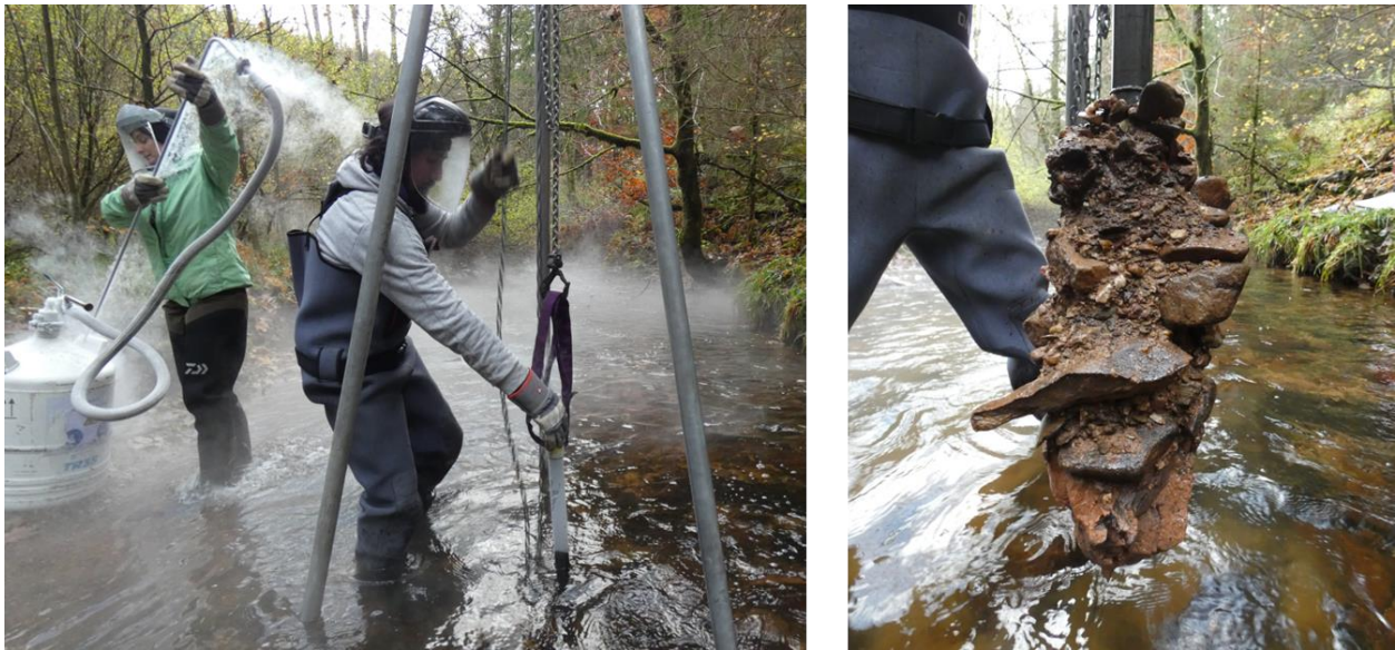
Abbildung 2-2: Sedimentprobenahme mittels der Freeze-core-Methode (links). Exemplarische Freeze-core-Probe aus dem Fließgewässer Prims (rechts) während der ersten Messkampagne im Herbst 2021.
