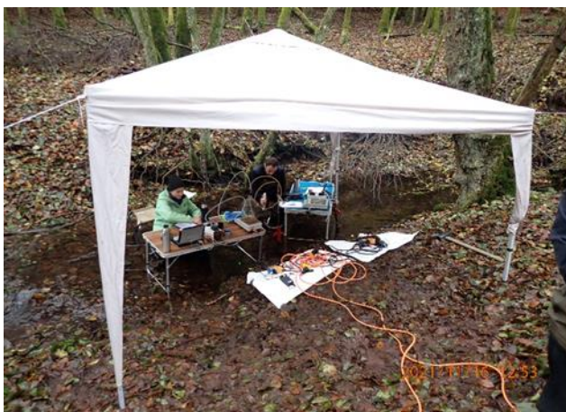
Abbildung 2-6-: Datenerfassung und Equipment zur Messung der vertikalen Profile von hydraulischen Leitfähigkeiten und des Gehalts an gelösten Sauerstoff mittels der VertiCO-Methode.
