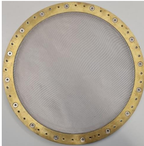
Abbildung 5: Modifiziertes Sieb zur Herstellung papierbasierter Sensoren
