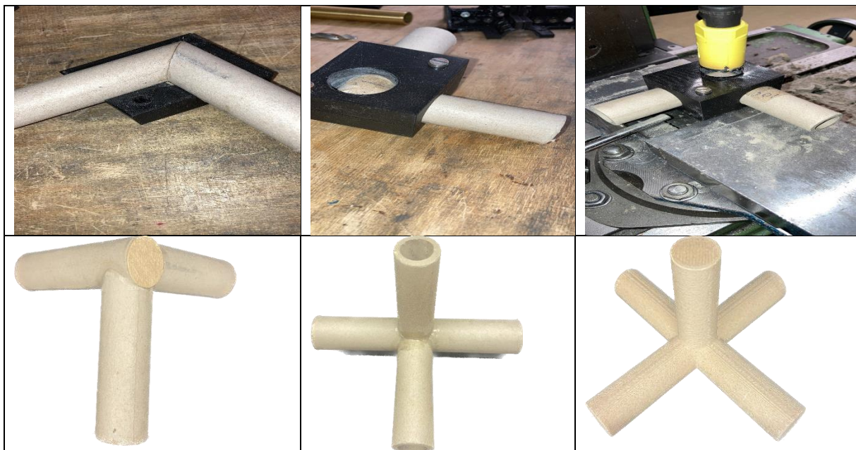
Abbildung 25: Verbindungselemente aus Papphülsen – Herstellung (Bilder oben) und fertige Elemente (Bilder unten)
