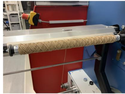
Abbildung 20: Umsetzung der wirtschaftlichen Herstellung von strukturgespulten stangenförmigen Elementen
