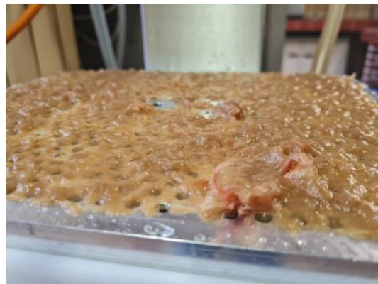
Abbildung 13: Kupferdrahtknoten in Grobrejekt zu sehen
