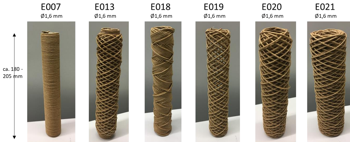
Abbildung 26: Prüflinge für die 3-Punkt-Biegeprüfung
