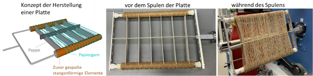
Abbildung 22: Konzept und Umsetzung der Herstellung von Platten nach Variante (3)
