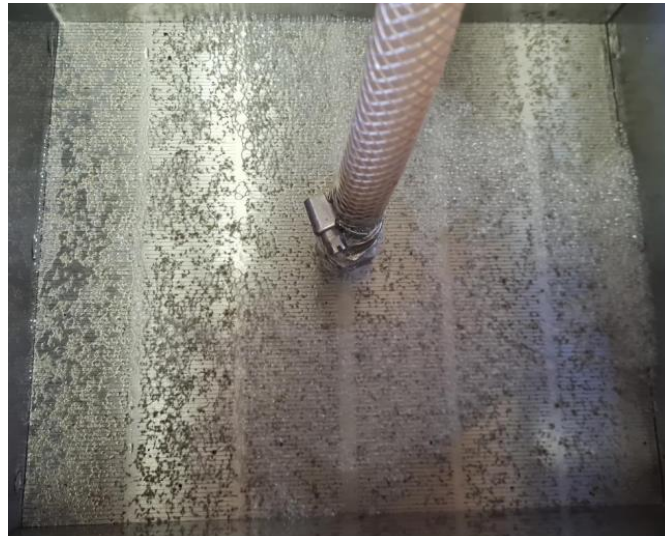
Abbildung 16: Schaumentwicklung bei der Feinsortierung von Papphülsen
