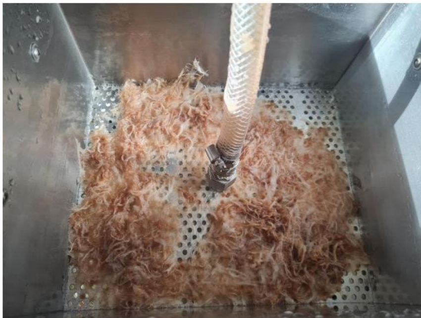
Abbildung 18: Grobrejekt von Quellvlies beim Recycling-Versuch
