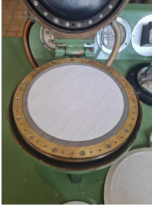
Abbildung 7: Trockener papierbasierter Sensor im Trockner, wobei der Trägerkarton entfernt wurde (liegt unten rechts)
