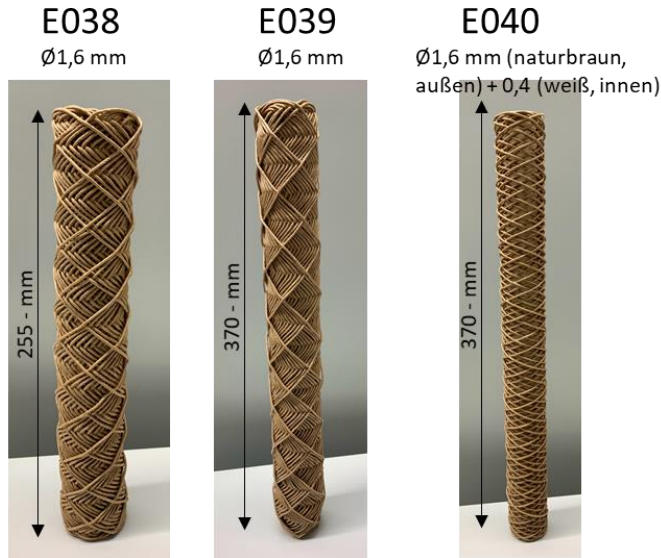
Abbildung 28: Für die Demonstrator-Theke eingesetzte strukturgespulte Elemente
