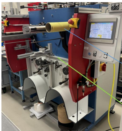
Abbildung 19: Sonderwickelmaschine JBF – MHW-2 im Spultechnikum der DITF
