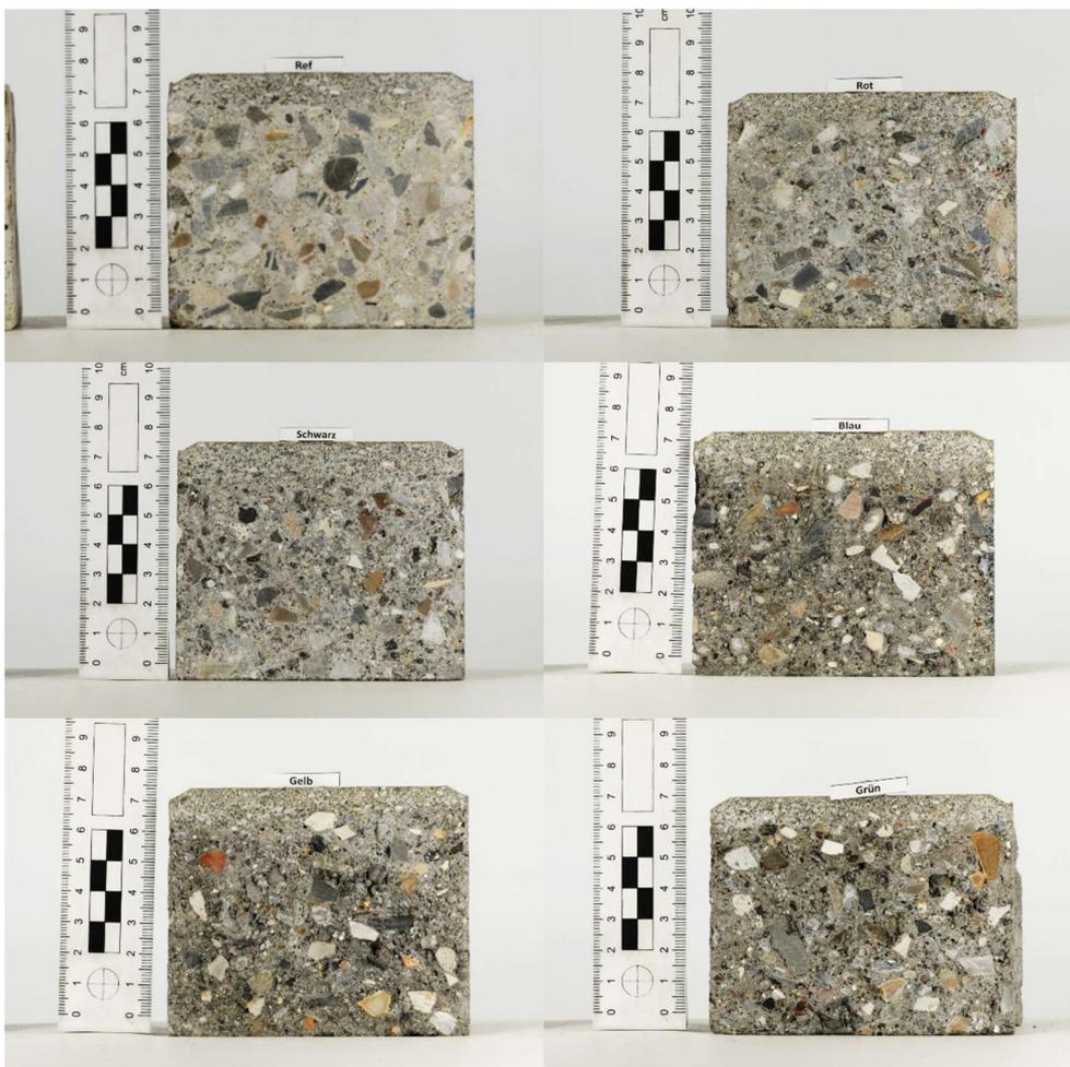
Abbildung 58: Querschnitte der Mischungen aus den Großversuchen
