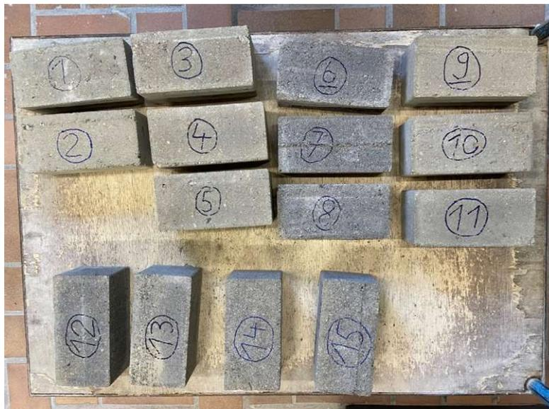
Abbildung 55: Für die CDF-Prüfung ausgewählte und nummerierte Pflastersteine der Technikumsversuche
