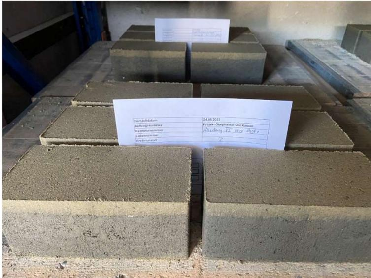
Abbildung 50: Pflastersteine der Mischung VI direkt nach Herstellung
