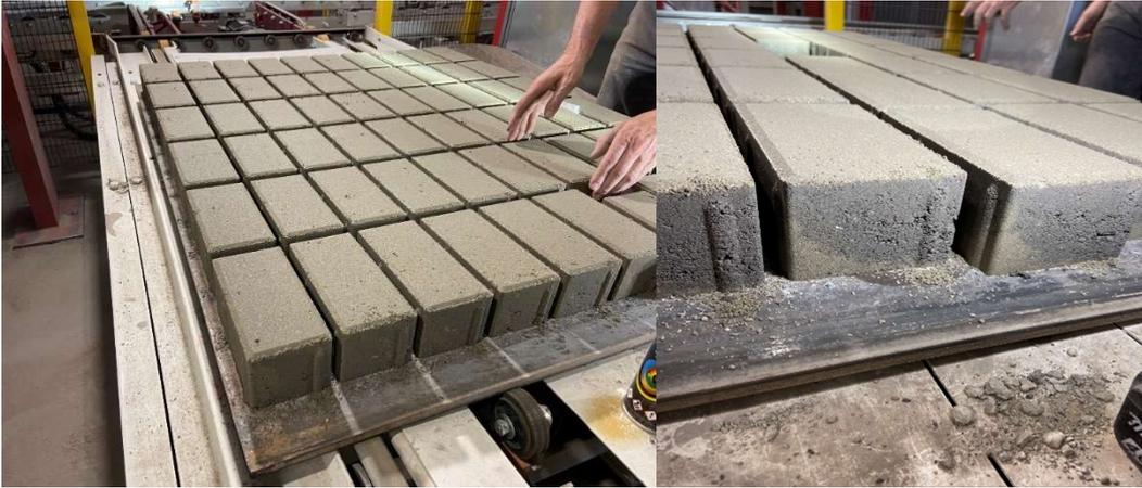
Abbildung 57: Pflastersteine der Großversuche direkt nach Herstellung
