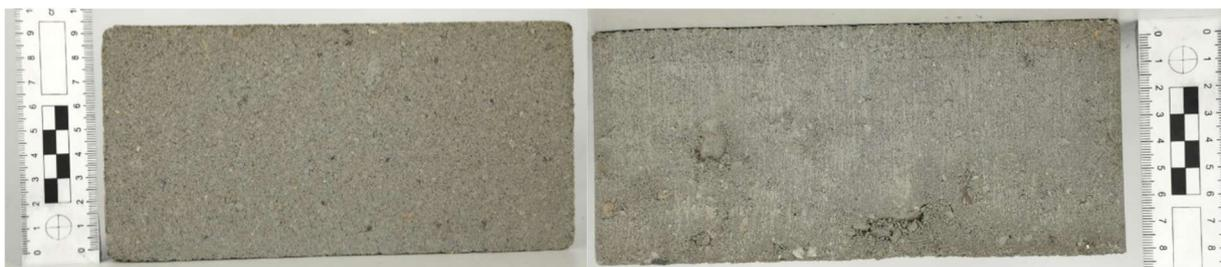
Abbildung 51: Draufsicht (links) und Seitenansicht (rechts) der Technikmischung III
