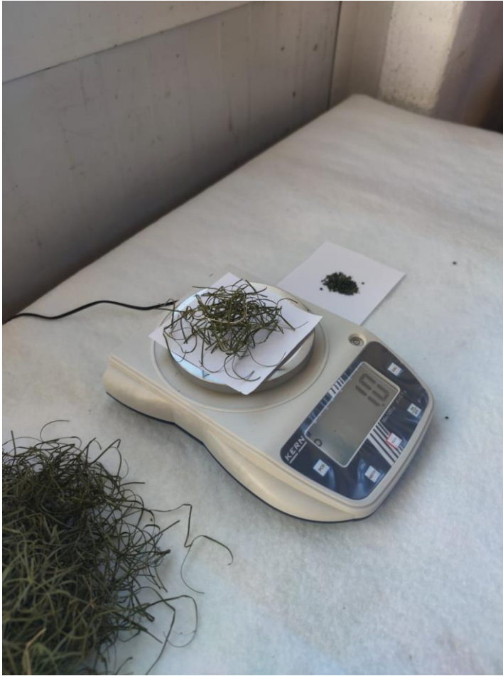
Abwiegen der ausgefilterten Mikroplastikteilchen und Fasern
