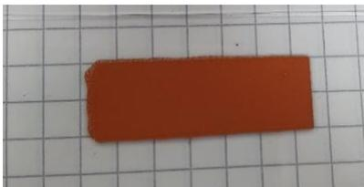
Abbildung 22: Beispiel für einen Druck auf Basis von Kupferpulver
