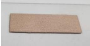
Abbildung 29: einen Druck auf der Basis von Silber-Kupfer-Pulver
