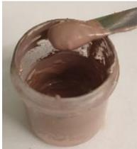
Abbildung 28: Paste aus AgCu 0204C-12 (silberbeschichtete Kupferflocken)
