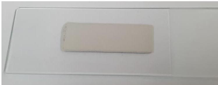
Abbildung 10: Gedruckte Probe aus vereinfachter Silberpaste
