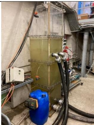
Fällungsreaktor mit Dosiertechnik
