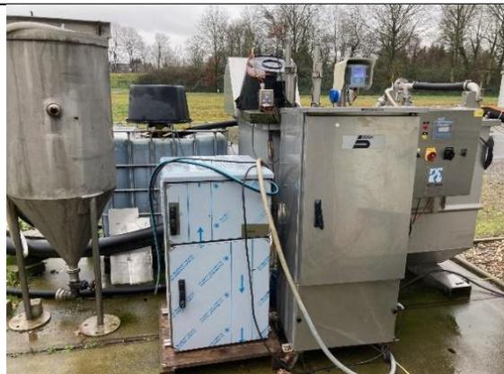
Trommelfilter, IBC für Spülwasser und automatischem Probennehmer (PN 7 & 9)
