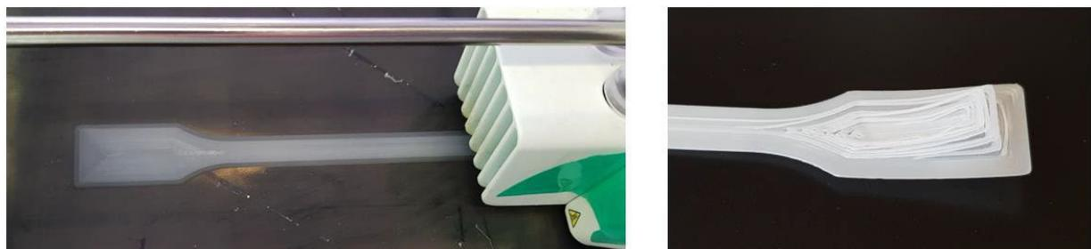
**Abbildung 14: 70:30-Material haftet auf TPU-Matte, Druckschichten lösen sich**
