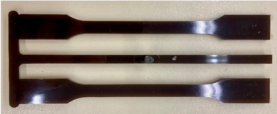
**Abbildung 3: Prüfkörper aus Feuerzeugmaterial gemäß DIN EN ISO 527-1**
