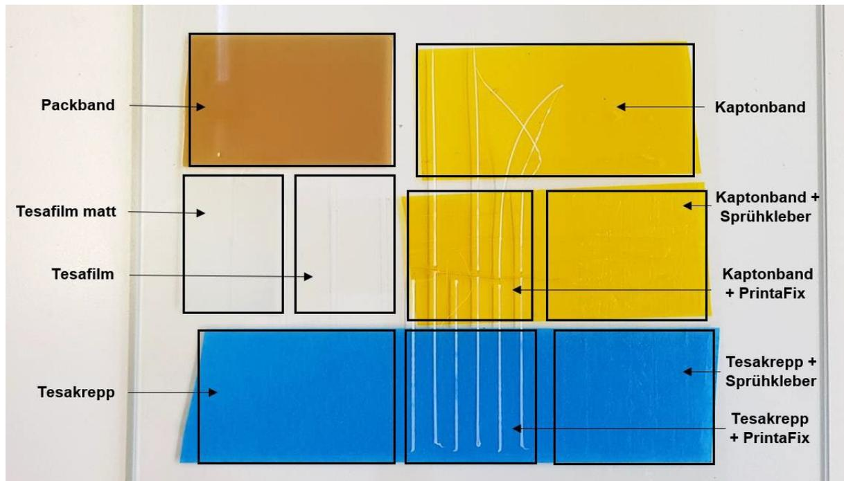
**Abbildung 13: Haftversuch POM-H auf verschiedenen Untergründen**
