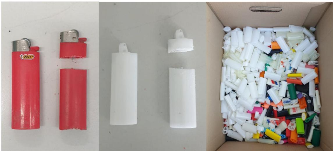
**Abbildung 19: "Kopfteil" Einwegfeuerzeug li., Abbildung 20: "Kopfteil" Gasbehälter der Stabfeuerzeuge re. Abbildung 21: POM-Tankmaterial aus Gasbehälter Stabfeuerzeuge und Einwegfeuerzeuge**
