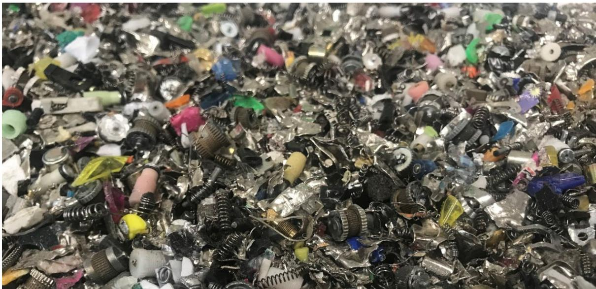
**Abbildung 12: Metallfraktion aus SAN-POM-Feuerzeugflakes**
