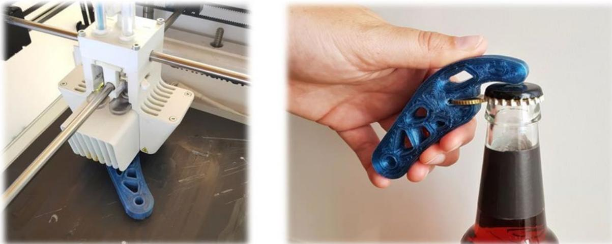
**Abbildung 17: 3D-gedruckter Flaschenöffner aus 100 % Feuerzeugmaterial**
