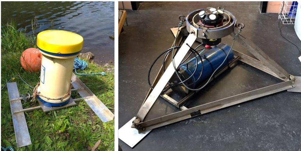
Abbildung 13: Profilierende Strömungsmesser (ADCP). links: RDI-ADCP mit Rahmen, der für 2 Wochen in der Wupper-Vorsperre installiert war; rechts: Signature 1000 Nortek ADCP der seit September 2020 in der Wupper-Vorsperre installiert ist.
