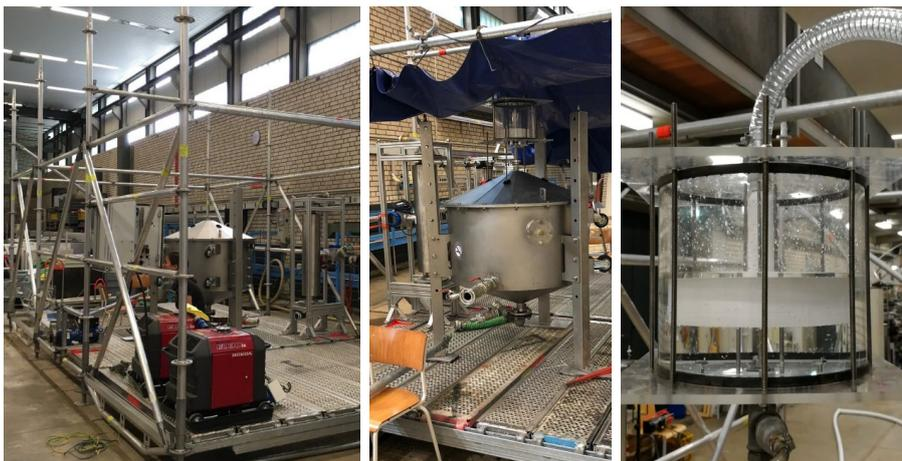
Abbildung 30: Aufbau des Prototyps im Labor der TH Köln, von links nach rechts: Plattform mit Gerätschaften, Gasabscheider, 3D-gedrucktes Schwimmerventil während des Betriebs.
