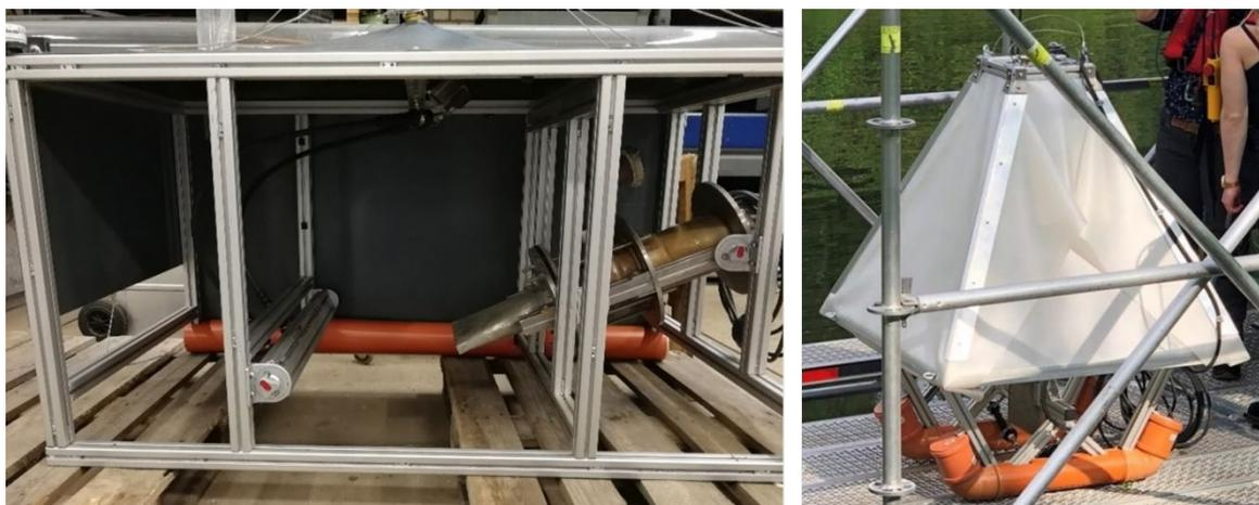
Abbildung 31: Gegenüberstellung der beiden Saugkopfvarianten. Links: alter Saugkopf, rechts: neuer Saugkopf.
