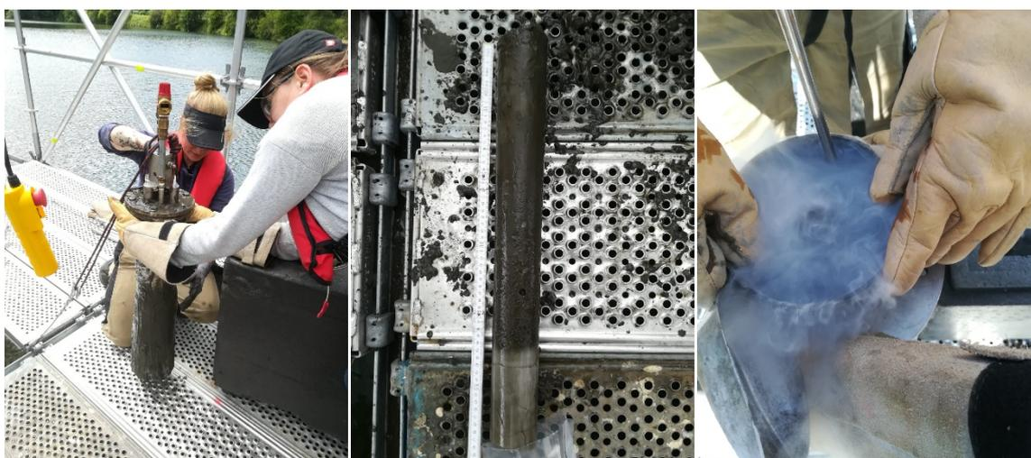
Abbildung 41: Entnahme von Gefrierkernen aus der Wupper-Vorsperre
