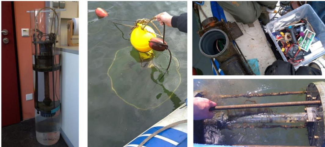
Abbildung 16: von links nach rechts: ABT Test und Rekalibrierung im Labor, ABT mit Trichter, Wartung einer oABT (rechts oben) und einer ABT (rechts unten).
