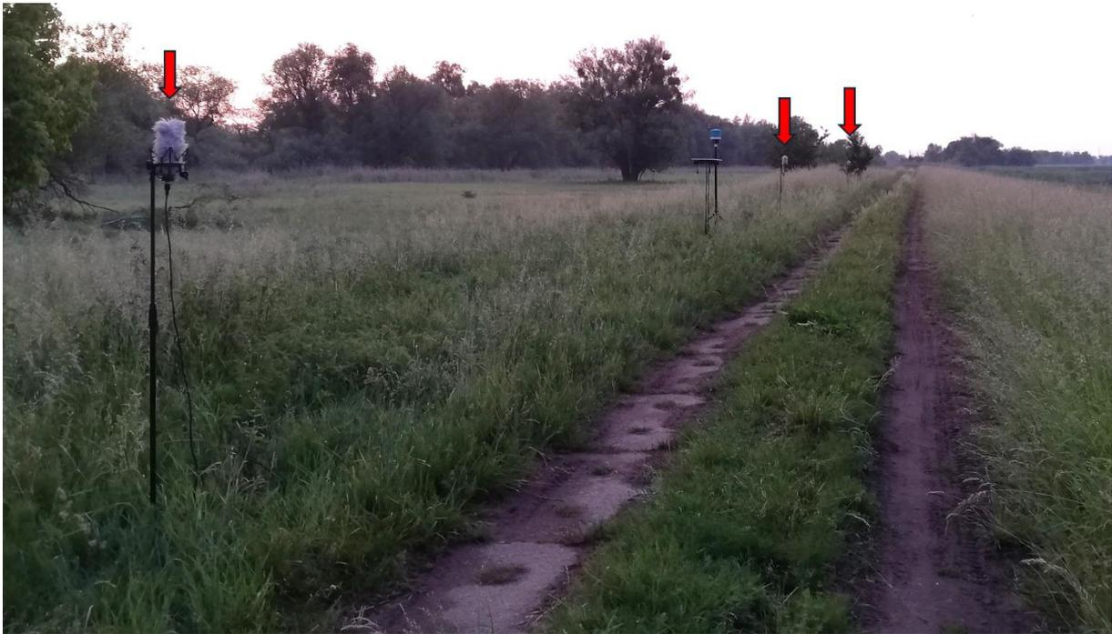
Abbildung 16: Versuchsaufbau zur Bestimmung der Reichweite eines DeVise-Sensors im Unteren Odertal. Mittels eines linear angeordneten Mikrofon-Arrays erfolgte die Ortung eines Wachtelkönigs mit paralleler Aufzeichnung des Schalldruckpegels. Die roten Pfeile kennzeichnen die Positionen der Mikrofone des Linienarrays.
