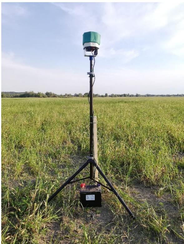
Abbildung 15: Daueraufzeichnung mit DeViSe-Sensor. Der auf Stativ in 1,80 m Höhe befindliche Sensor wurde mit einem Pfahl gesichert. Die Energieversorgung erfolgte über eine externe Autobatterie
