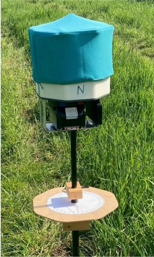
Abbildung 22: DeViSe-Sensor mit Stativ bei der Lautsprechermessung. Im unteren Teil ist der Drehteller zu sehen, mit dem die Ausrichtung des Sensors eingestellt werden kann.
