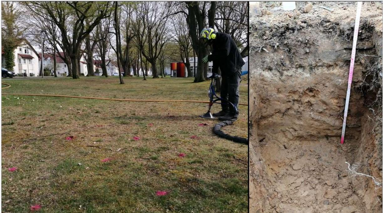
Abbildung 2: Sandfläche in Bad Arolsen während der Druckluftinjektion (links) und Bodenprofil (rechts).
