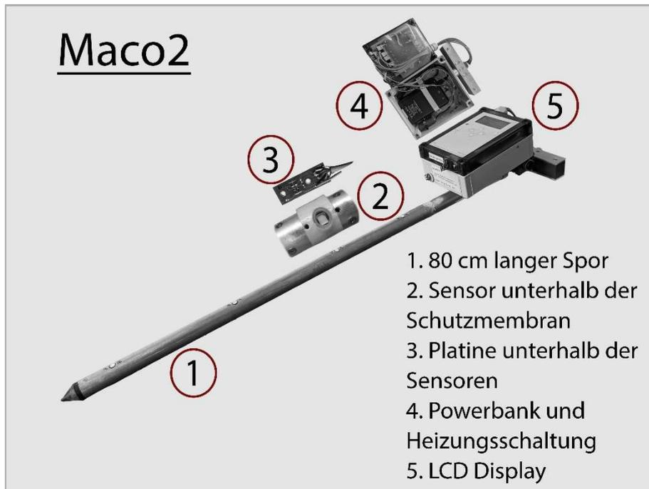
Abbildung 6: Aufbau der Profilsonde.
