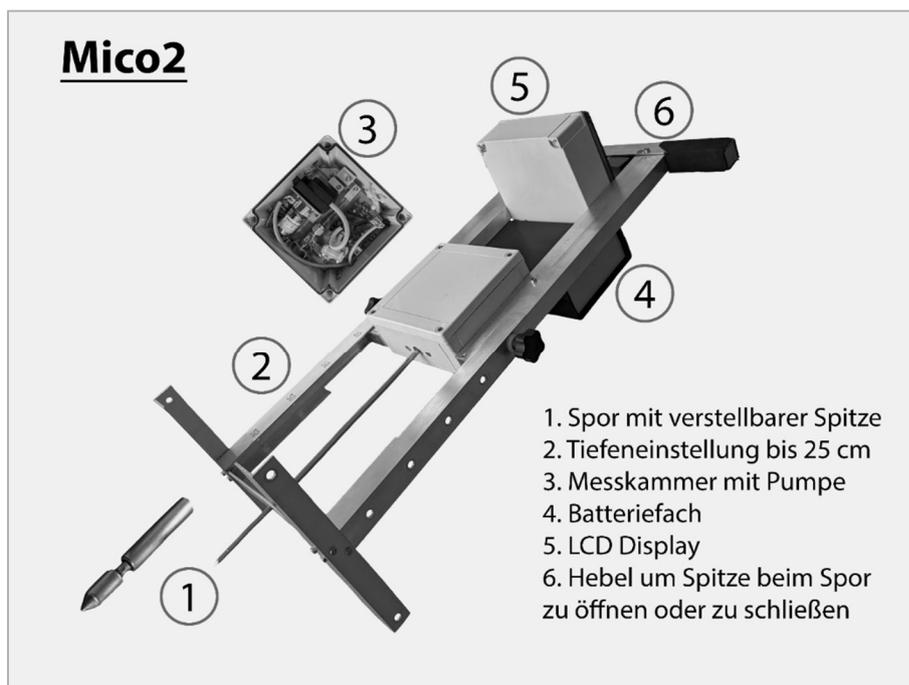
Abbildung 5: Aufbau des mobilen CO<sub>2</sub>-Messgeräts mit Infrarot-Sensor.
