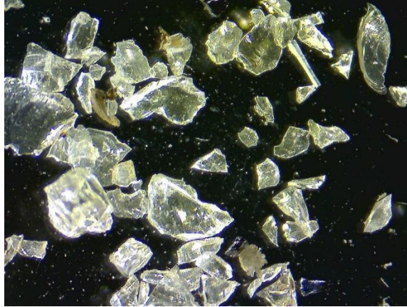
Abbildung 41: Glaspartikel in unterschiedlicher Korngröße und Kornform.
