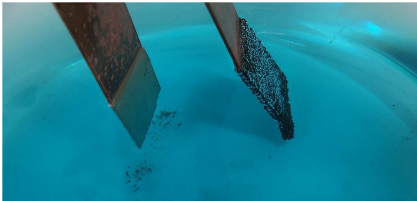
Abbildung 49: Elektrochemischer Versuch zur Abscheidung von Silber.
