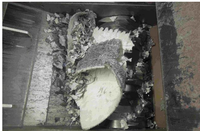
Abbildung 12: Exemplarische Zerkleinerung eines kristallinen Photovoltaikmoduls im Einwellen-Zerkleinerer.
