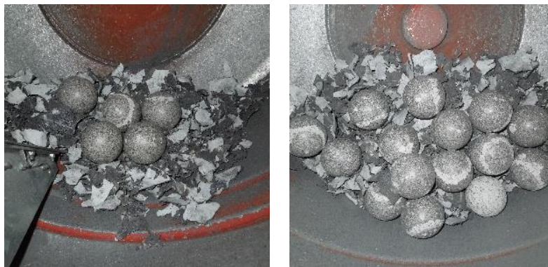
Abbildung 27: Darstellung von zwei Versuchen in der Trommelmühle mit variabler Probenmasse und Kugelanzahl.
