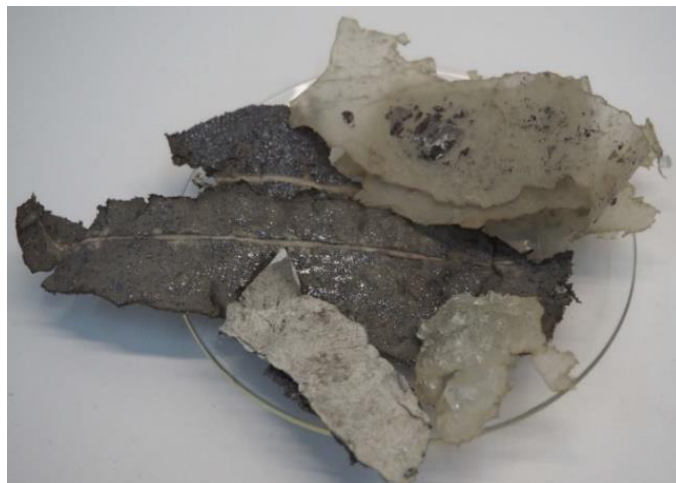
Abbildung 52: Grobe Kunststoffstücke nach der Zerkleinerung in der Hammermühle.
