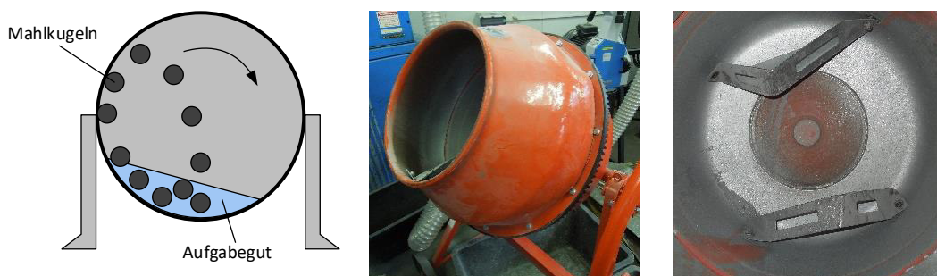
Abbildung 26: Funktionsweise der eingesetzten Trommelmühle mit Blick in den Innenraum.
