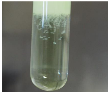
Abbildung 44: Sichtbarer Niederschlag nach der Zugabe von Salzsäure.
