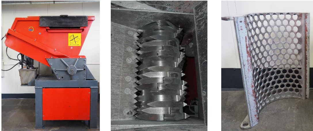
Abbildung 11: Erdwich EWZ 550 Einwellen-Zerkleinerer mit Ansicht der Messer und dem einsetzbaren 30 mm Lochsieb.
