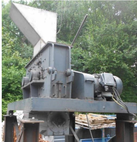
Abbildung 51: Eingesetzte Hammermühle zur Nachzerkleinerung des Materials.
