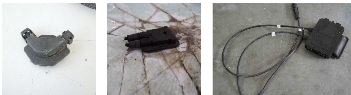
Abbildung 9: Verschiedene Anschlussdosen von Photovoltaikmodulen.
