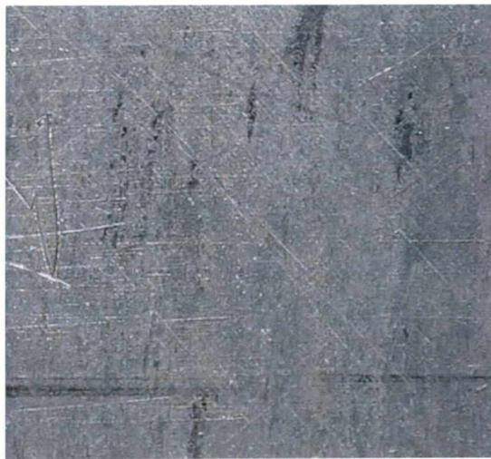
Abbildung 1: unbehandelte Aluminiumgussoberfläche mit Kratzern, Trennmittel und anderen Verunreinigungen.
