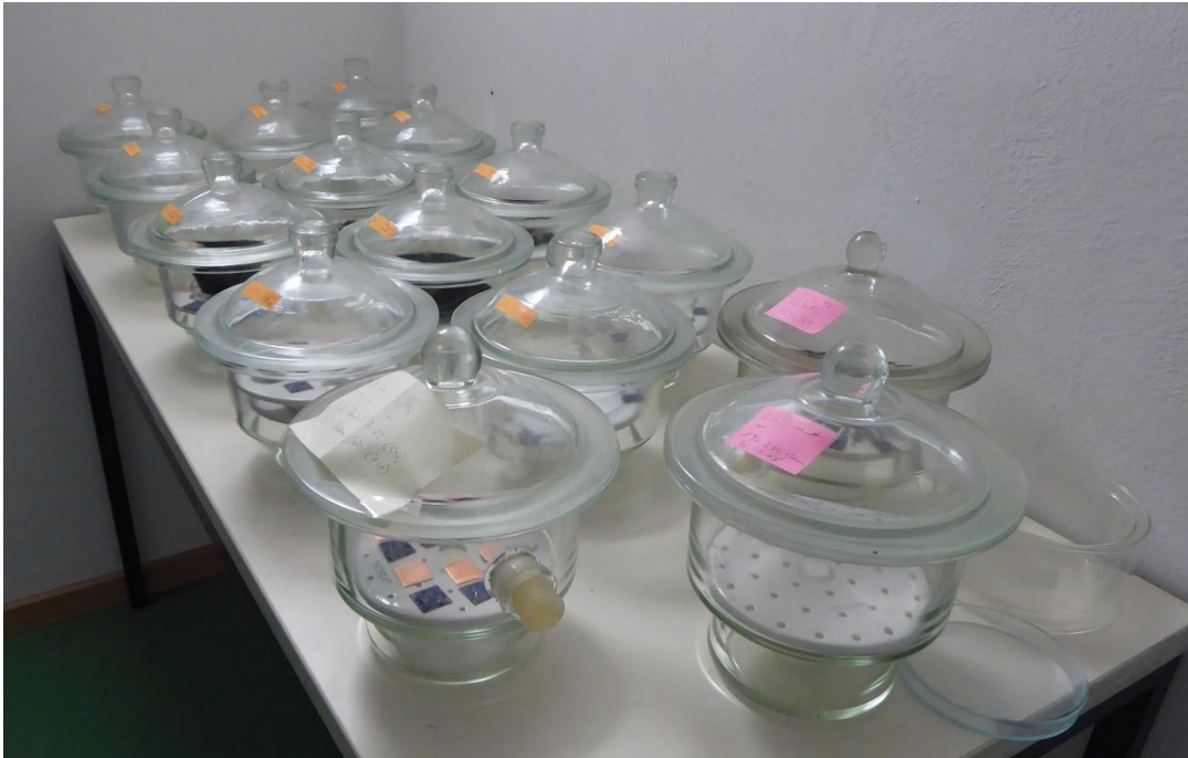
Kupfer, Messingplättchen und Emailplättchen in Exsikkatoren mit unterschiedlicher relativer Luftfeuchtigkeit sowie Schadstoffabsorbentien und Schutzlacken und 4% Formaldehyd
