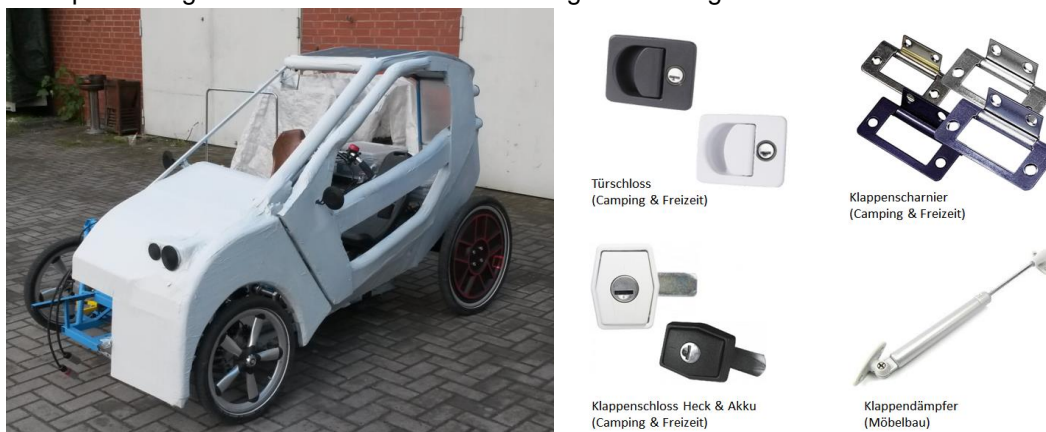
Abb. 31: Geometrie- und Funktionsmodell der Lamborghini-Tür
