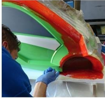
Laminieren eines Werkzeuglostteils
