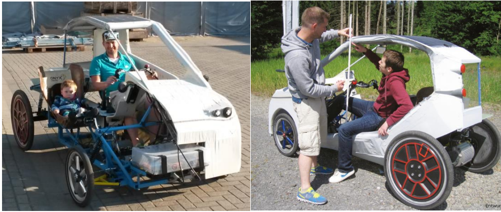
Abb. 62: li. Testfahrt mit Akku to go- Prototy; re. Test & Optimierung der Einstiegssituation
