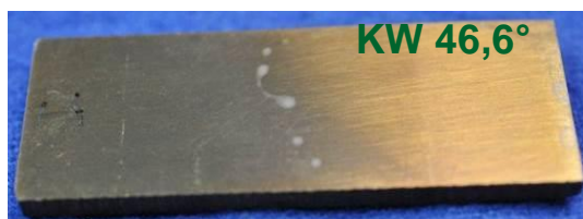
Abbildung 10: TEOS-Sol (1. Lage) als Haftgrund, TEOS-TMES-Sol (Rez. 4), 1 Lage (5min), 250°C, 2h (Probe S55)
