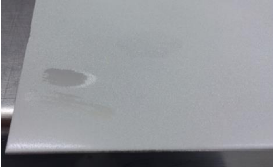
Abbildung 116: TEOS-Sol FS1 / 1 Schicht / 1,0 bar / nach 60 min bei 190 °C / mit Finger abgerieben
