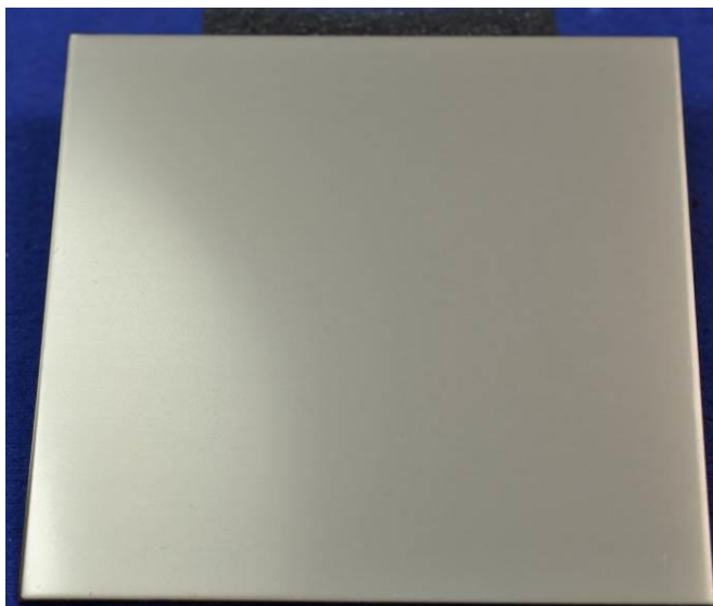
Abbildung 114: MTES-Sol, partikelgefüllt / 2 Schichten / 1,5 bar / nach 120 min bei 300 °C tempern
