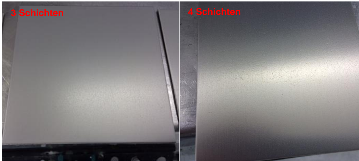
Abbildung 113: MTES-Sol, partikelgefüllt / 3 und 4 Schichten / 1,5 bar / nach 60 min bei 190 °C tempern / mit Fingernagel geritzt
