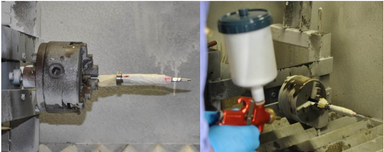
Abbildung 117: Sprühbeschichten des Formeinsatzes mit dem Einsatz der drehbaren Einspannvorrichtung
