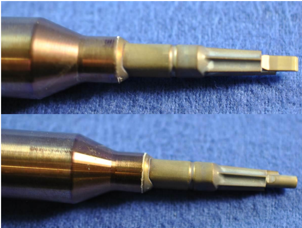
Abbildung 119: Sprühbeschichteter Formeisatz nach dem Tempern bei 300°C, 2h, Rampe 200K/h
