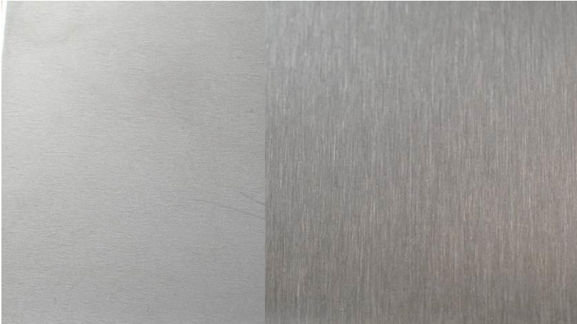
Abbildung 108: V2A-Plättchen: glatte Oberfläche-links, gebürstete Oberfläche- rechts
