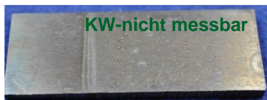
Abbildung 11: TEOS-MTES-Sol (Rez.2), 4 Lagen (5 min), 350°C, 2h (Proben S27, S36)
