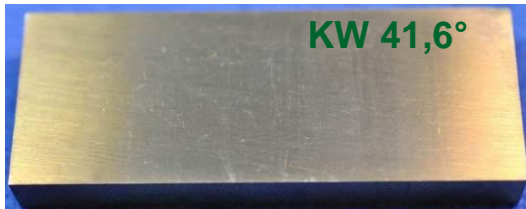
Abbildung 23: TEOS-Sol als Haftgrund (1. Lage), MTMS-Sol (Rez.5), 1 Lage (16h), 250°C, 2h (Probe S57)
