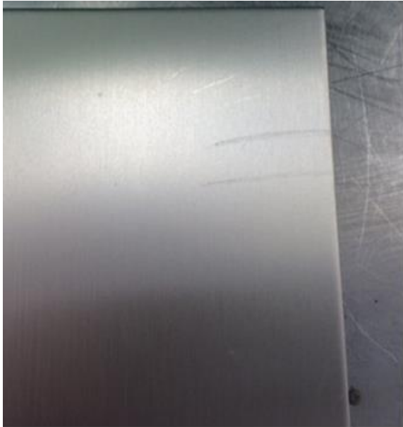
Abbildung 111: MTES-Sol, partikelgefüllt/ 1 Schicht / 1,5 bar / nach 60 min bei 190 °C tempern mit Fingernagel geritzt
