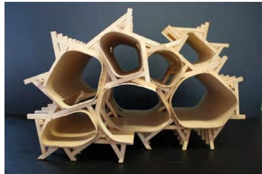
Abb.1\_Modell der Holzkonstruktion mit parallelen Rahmen und Beplankung zur Queraussteifung
