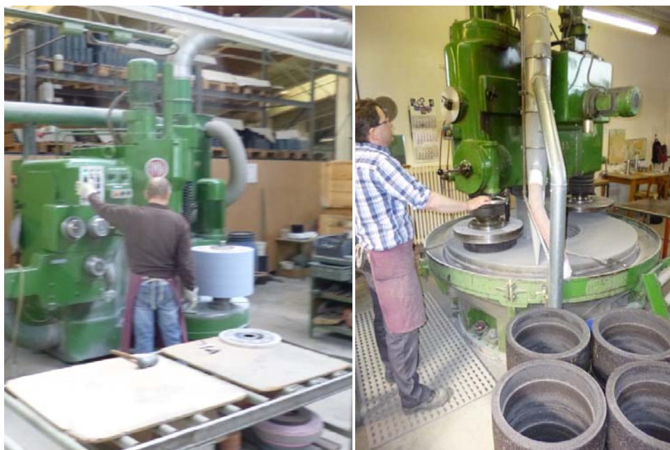
Abbildung 9: Mitarbeiter beim Profilieren (links) und beim Planieren (rechts)
