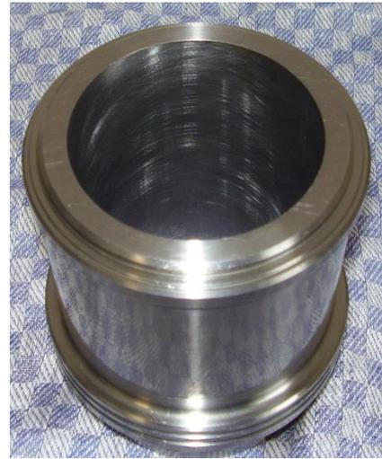
**Abbildung 4.24 Wassermantel und Zylinderlaufbuchse**
