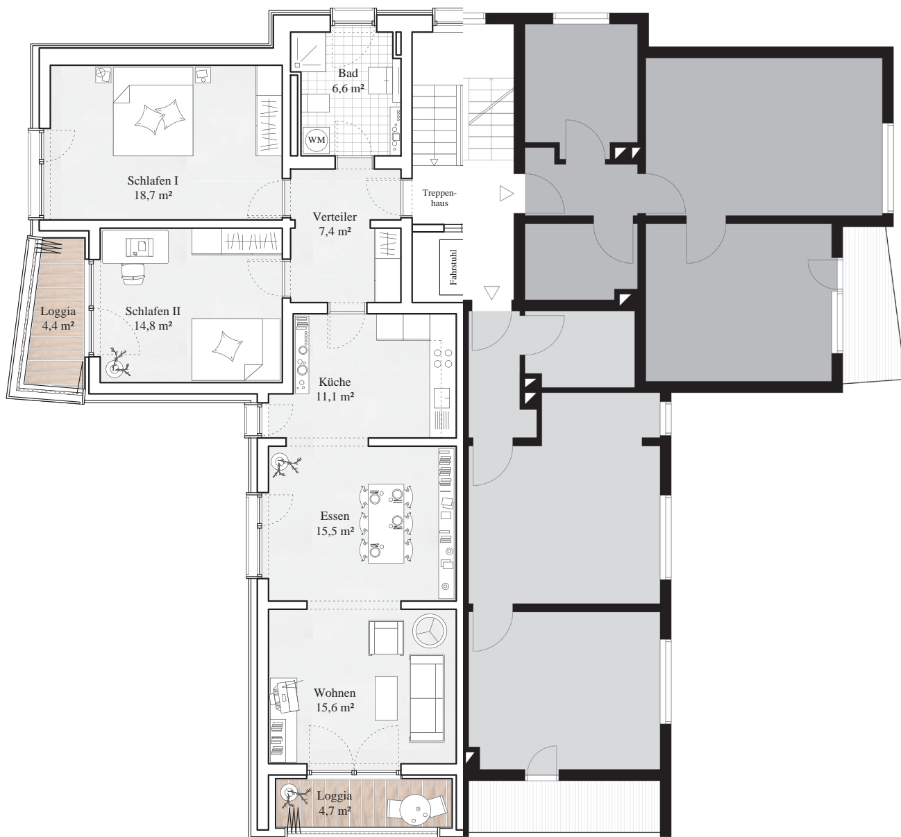
Abb. 12: Grundriss links Sanierung und rechts Bestand
