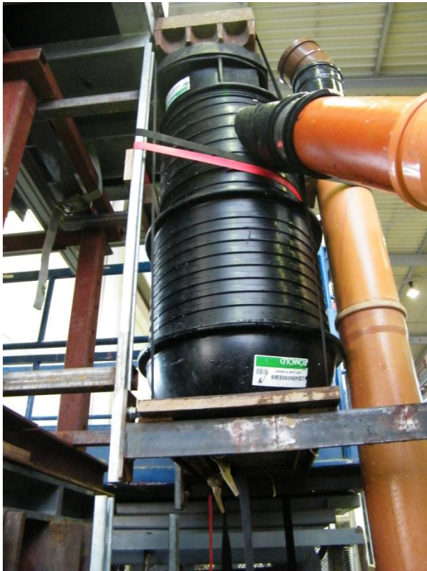
Abb. 45: INNOLET G auf dem Versuchsstand beim IKT (Trumme aus Kunststoff, baugleich mit Hamburger Trumme aus Beton)
