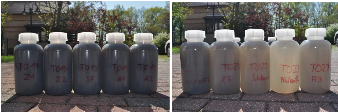
Abb. 36: Vergleich Zulauf/Ablauf, links Trumme ohne INNOLET G, rechts: Trumme mit INNOLET G im aufgeschüttelten Zustand
