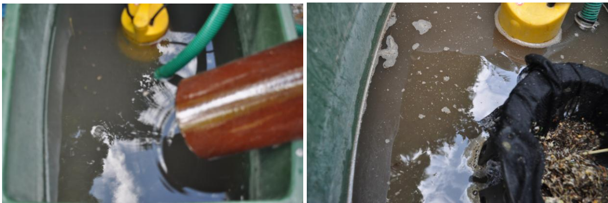
Abb. 20: Links Ablauf nach Versuchsende Trumme mit Filter (INNOLET Substrat), rechts Trumme ohne Filter mit aufgefangenen Schwimmstoffen
