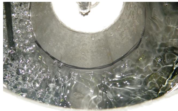
Abb. 45: INNOLET G auf dem Versuchsstand beim IKT (Trumme aus Kunststoff, baugleich mit Hamburger Trumme aus Beton)
