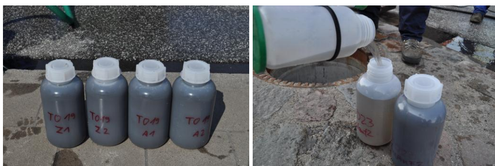
Abb. 35: Vergleich Zulauf/Ablauf, links Trumme ohne INNOLET G, rechts: Trumme mit INNOLET G bei der Probenahme
