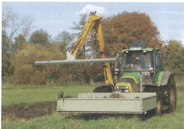
Ein neu entwickeltes Gerät zur Krebschereverpflanzung mit Entnahmeforken und Transportwanne (Foto: K. Kunzelhaneg)
