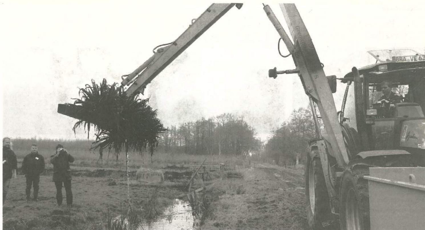
Im Hollerland im Einsatz: Ein neu entwickelter „Krebscherenpflücker“. Mit der hydraulisch gesteuerten Forke können Krebscheren schonend in andere Bereiche umgesetzt werden, um die Vermehrung der zweigeschlechtigen Pflanzen zu fördern.
