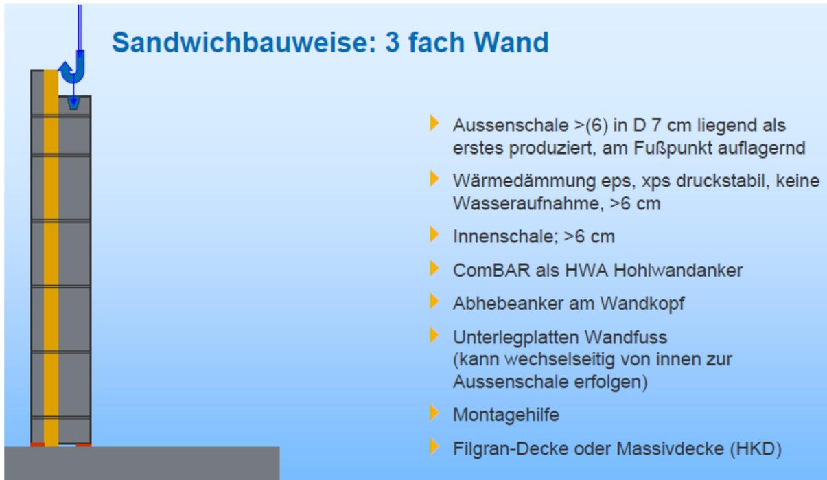
Abb. 22: Wandaufbauschema bei Ausführung als innengedämmte 3-fach Wand (ohne Hohlraum) hergestellt im Fertigteilwerk
