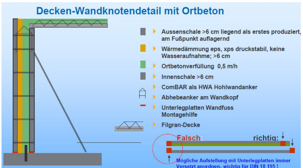
Abb. 23: Verarbeitung des Deckenanschlusses auf der Baustelle
