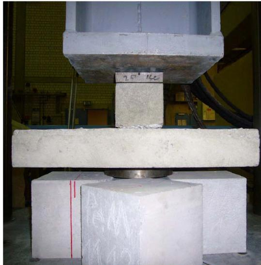
Abb. 4: Versuchsaufbau zur Untersuchung des Durchstanzverhaltens
