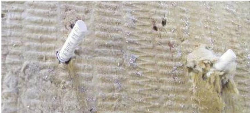
Abb. 18: *Verarbeitung von Rockwool-Dämmplatten (rechts ohne Einsteck-Hülse: es entstehen Faserausfransungen, die die Rippen der Stäbe zusetzen, links: mit Einsteckhülse)*
