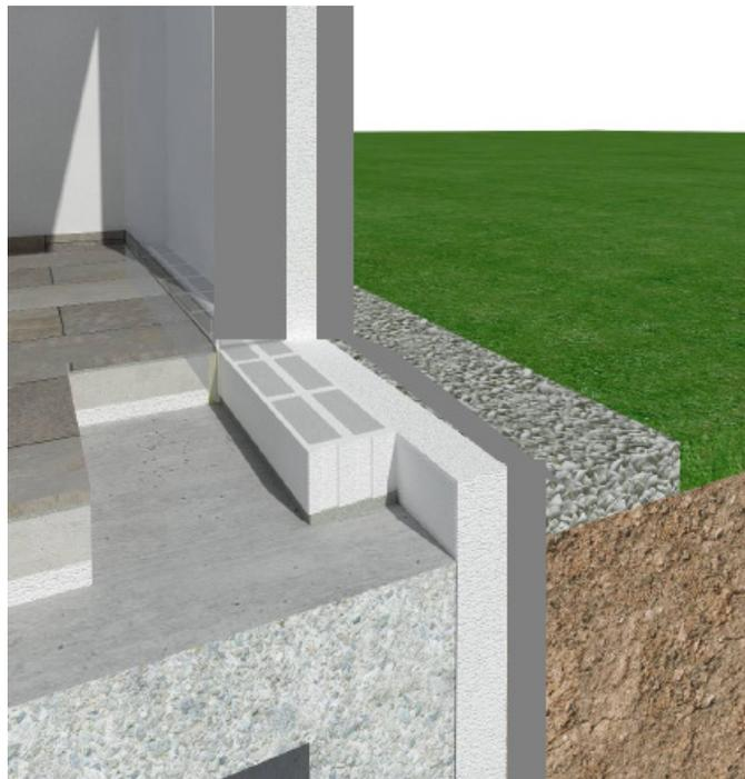
Abb. 25: Boden-/Geschossdeckenanschluss über Schöck-Novomur-Elemente
