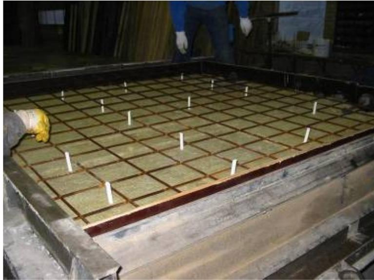
Abb. 29: Versuch im Fertigteilwerk zum Einbau von Rockwool-Dämmung
