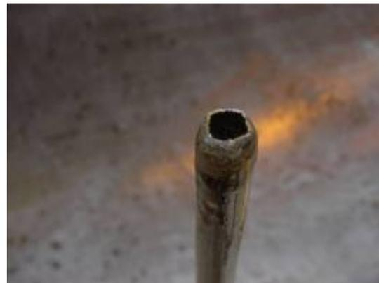
*Abb. 31: Entwickeltes Werkzeug zum Einbringen von Löchern in Dämmstoffplatten für ComBAR®-Stäbe*
