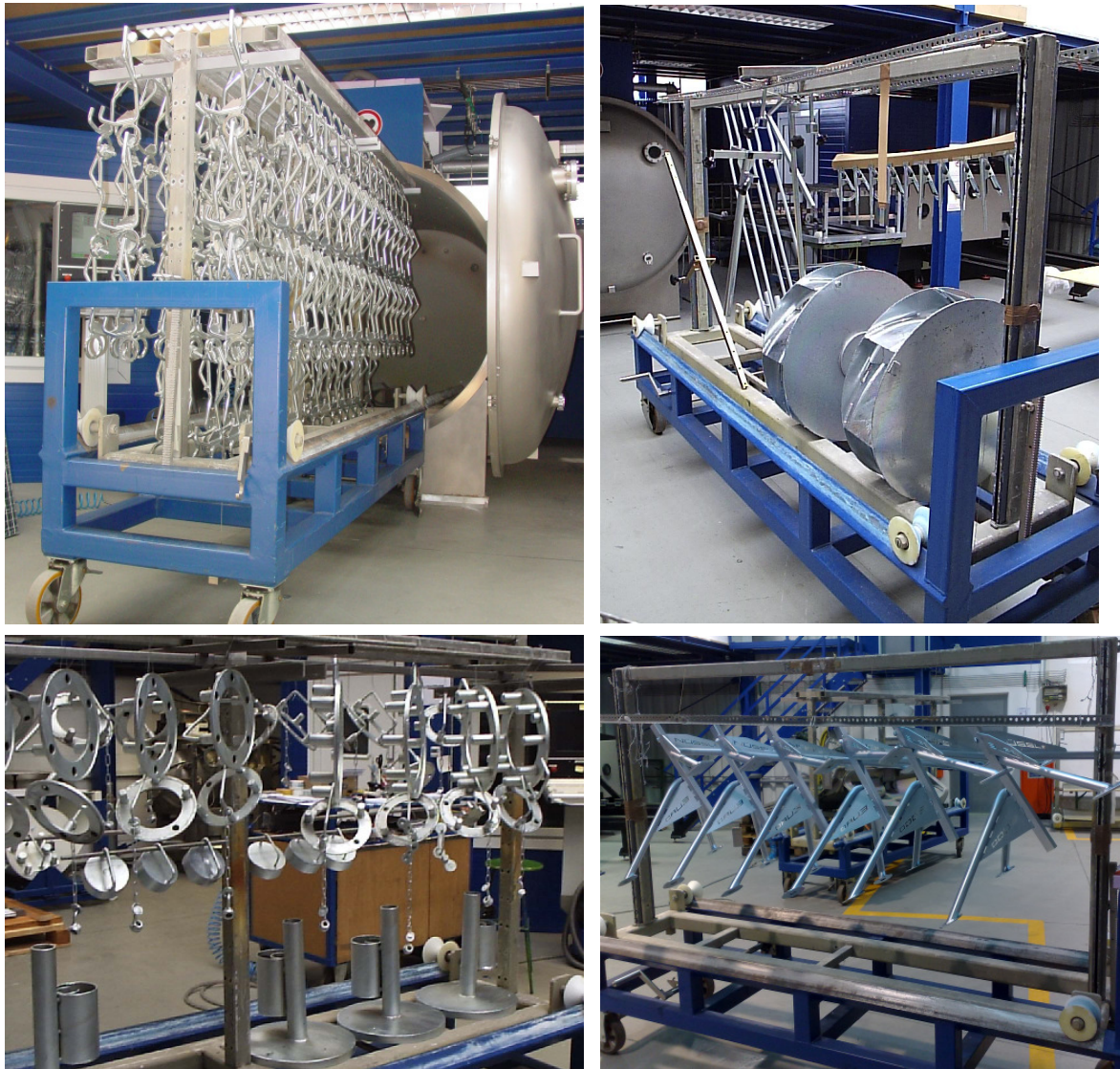
Bild 2: Beschickung des 5 m 3 Plasma-Beschichtungsreaktors mit exemplarischen Komponenten aus Lackierstraßen.
