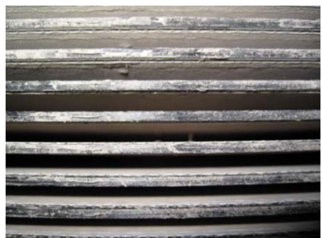
Abbildung 29: Membranmodul im Trockenschrank und angebackene Deckschicht
