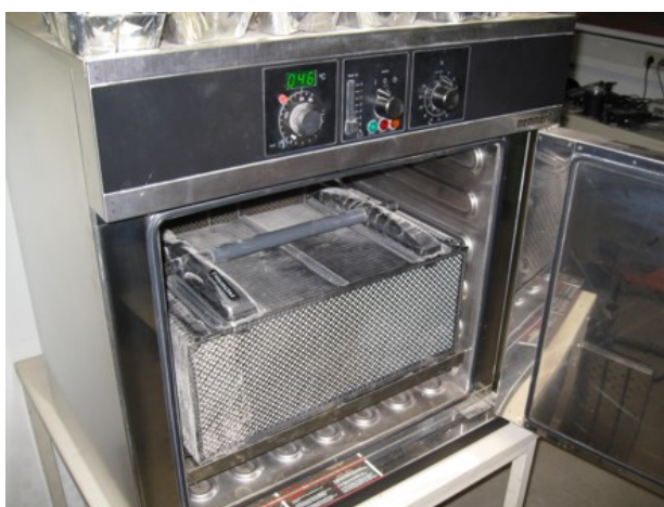
Abbildung 29: Membranmodul im Trockenschrank und angebackene Deckschicht
