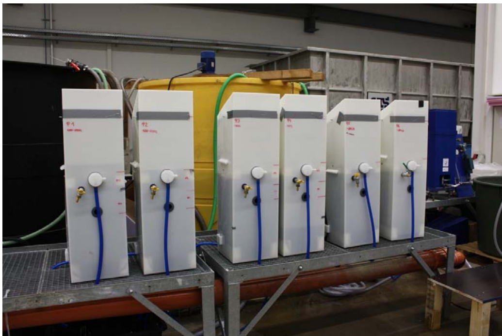
Abbildung 26: Versuchsstand zur Untersuchung des Einflusses der Betriebsweise auf den Keimrückhalt / Untersuchung hoher Keimbelastungen
