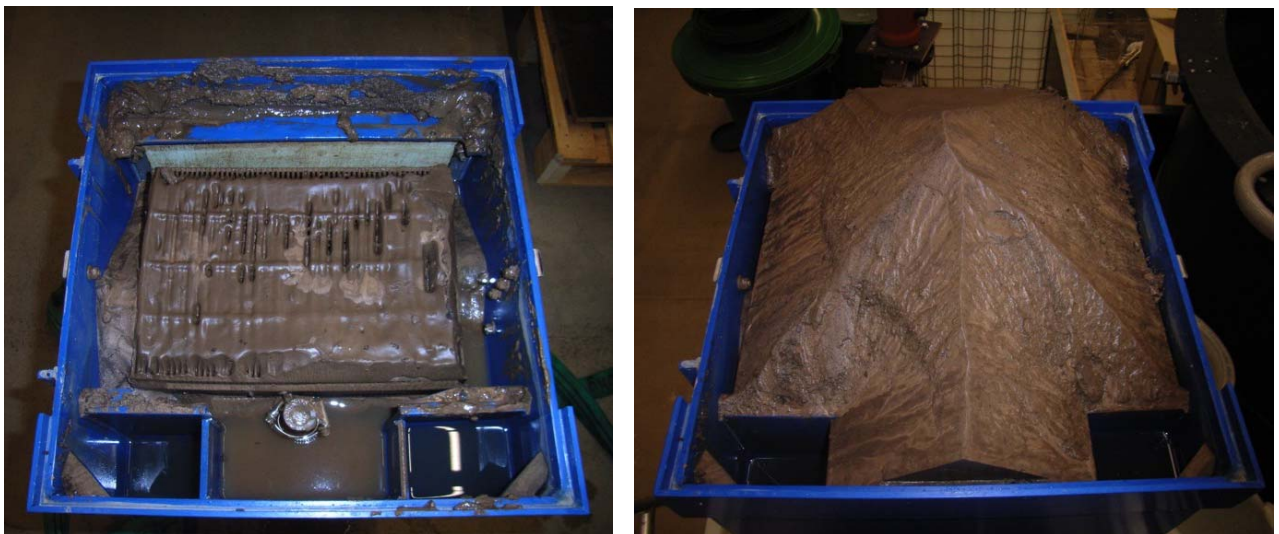
Abbildung 25: Verschlämzung der Membran und des Gehäuses
