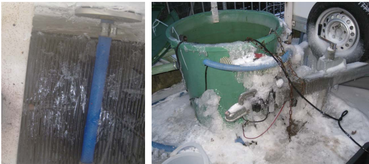
Abbildung 30: Eingefrorenes Membranmodul und eingefrorener Versuchsstand
