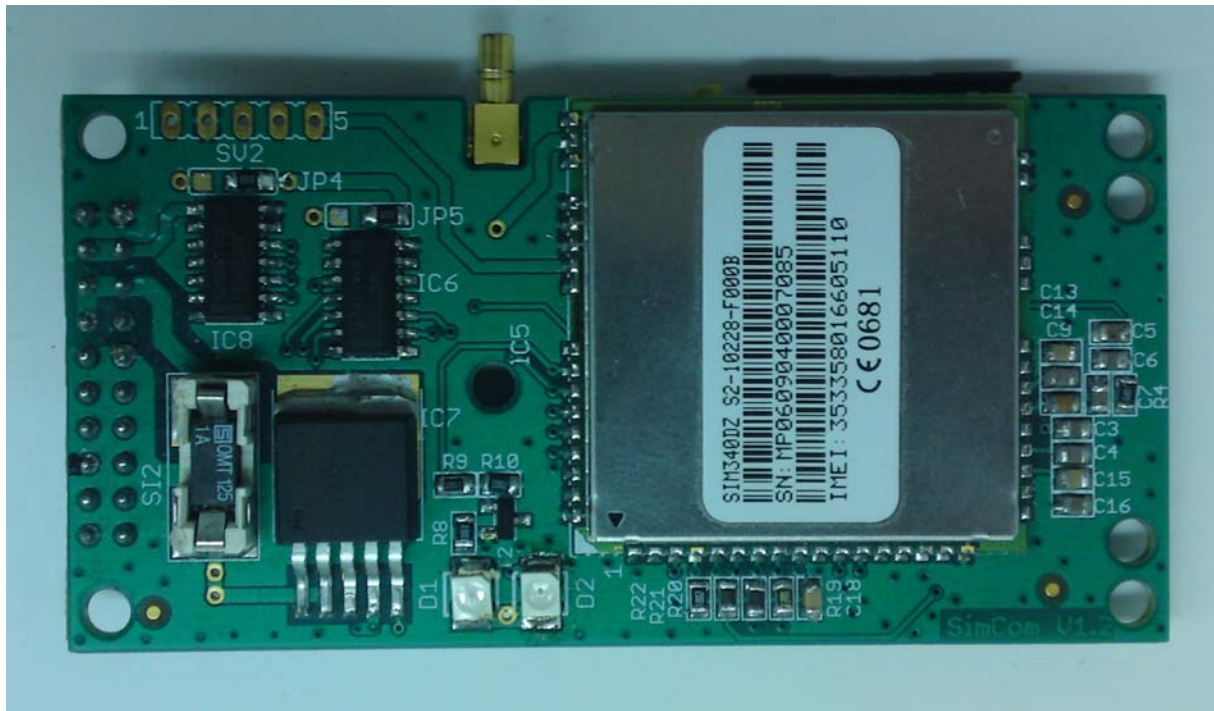
Abb.6: GSM-Modemplatine mit Antennenanschluss. GPRS-Klasse10-fähig, mit integriertem TCP/IP-Stack, FTP und POP3
