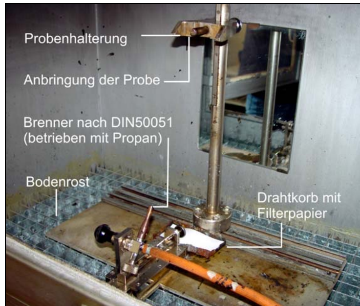
Abb. 17: Prüfung B2 - Brennkasten nach DIN 50051
