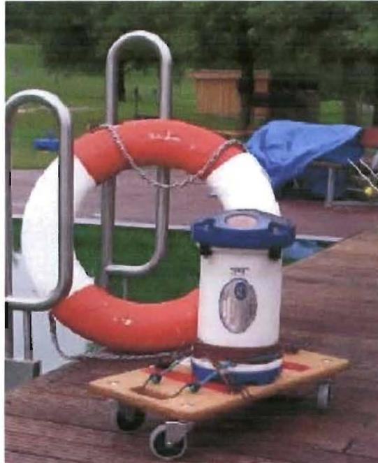
Abbildung 7: ADCP auf Rollwagen, um das Gerät am Beckenboden einfacher positionieren zu können.
