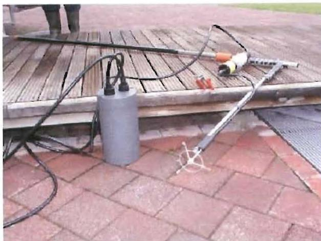
Abbildung 4: Akustischer Doppler-Vektor-Strömungsmesser (ADV)
