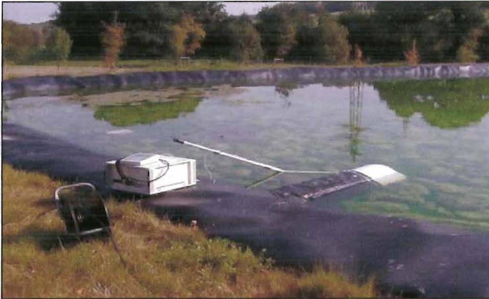
Abbildung 10: Fluoreszenzmessgerät am Ablauf des Bodenfilters
