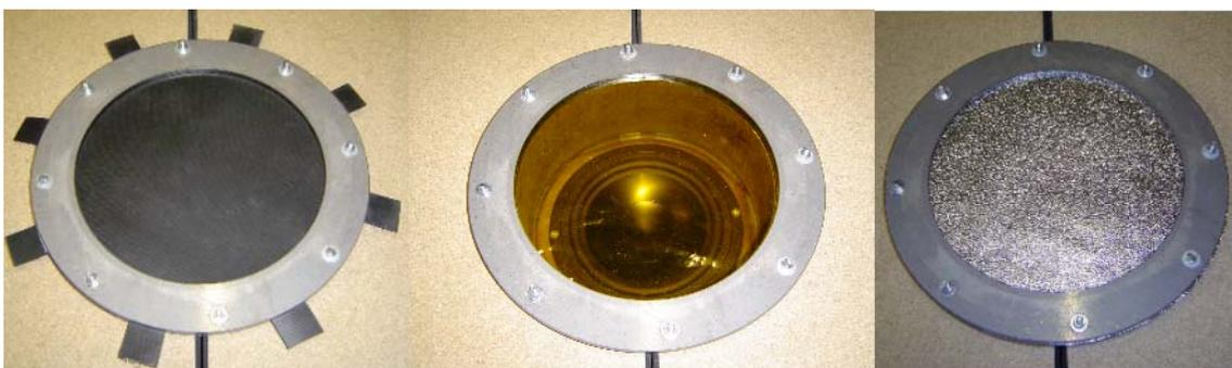
Abb. 1.2: Verschiedene Folienabdeckungen am Konuslautsprecher; links: NPG-Folie; Mitte: Kapton-Folie; Rechts: Edelstahlfolie [Köc04]
