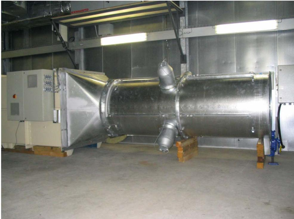
Abb. 4.1: ANC-Schalldämpfer-Prototyp im Technikumsprüfstand
