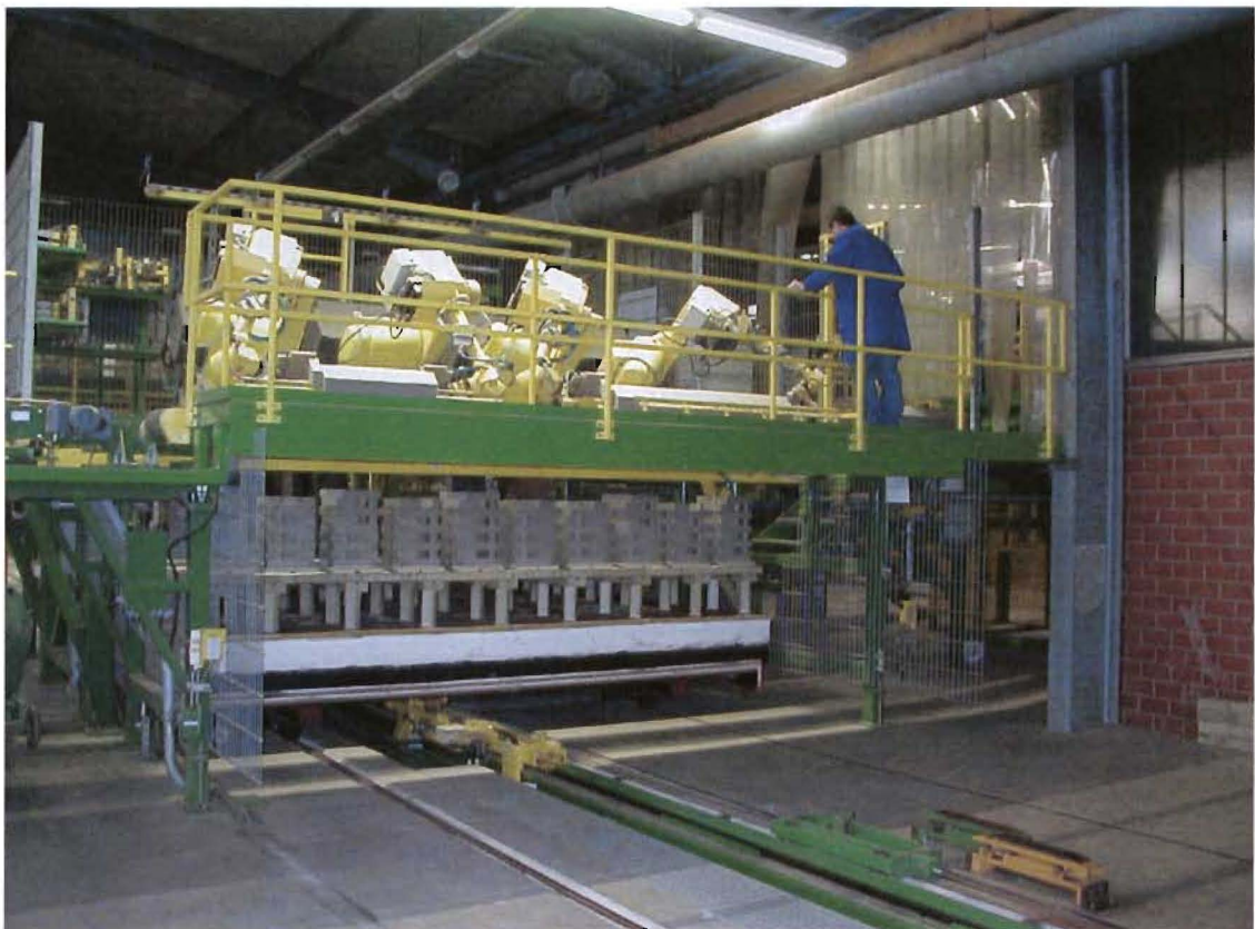
Abbildung 17: Neue Besatzart der Dünnbettriemchen mit Abstand zum Ofenwagen, um die Werkstücke gleichmäßig mit Luft zu umspülen.
