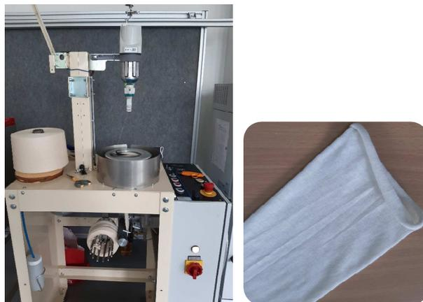
**Abbildung 1: Rundstrickmaschine TK-83-L der Fa. Harry Lucas, Maschinenfeinheit E24 (links) und die damit erhaltene Schlauchware (rechts).**
