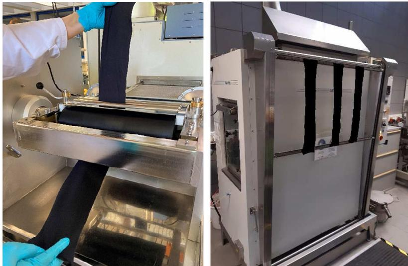
**Abbildung 6: Ausrüstung am Foulard der Fa. Feyen, Typ DL-2500-HV (links); Trocknen / Kondensieren am Dampf-Trockner der Fa. Mathis (rechts).**
