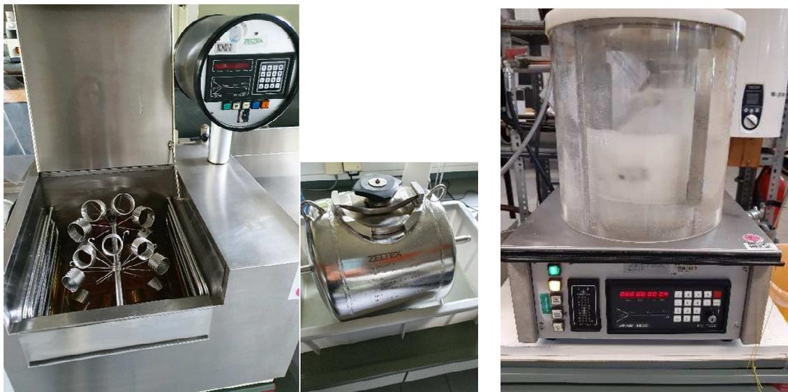
Abbildung 5: Polycolor-Becherfärbeapparat der Fa. Zeltex (links), HT-Färbetrommel-Einsatz (Mitte), Soapy der Fa. Zeltex (rechts)
