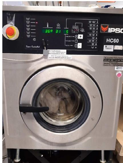
**Abbildung 3: Gewerbliche Trommelwaschmaschine Typ HC60 der Fa. ISPO für die Vorbehandlungen.**
