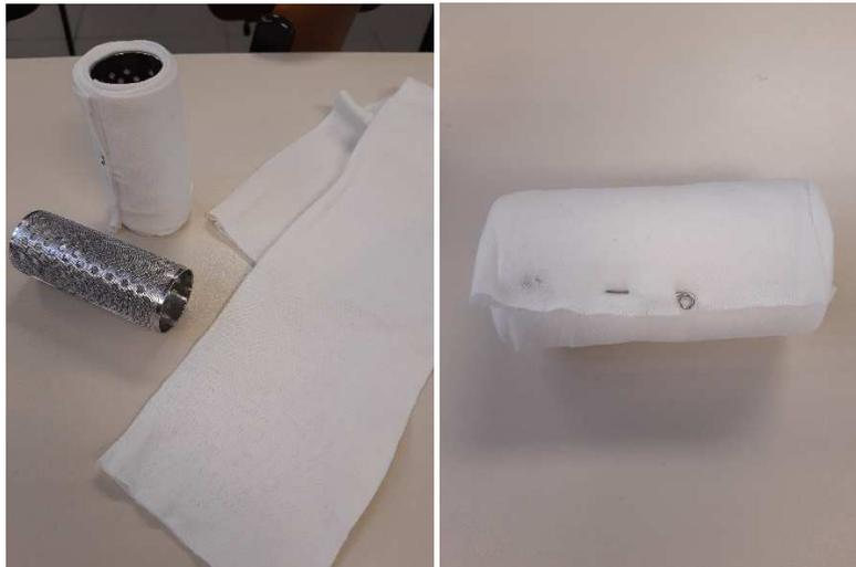
Abbildung 4: Vorbereitung zum Wickeln der Garnfärbe-Edelstahlhülse (links), fertig umwickelte Hülse (rechts).
