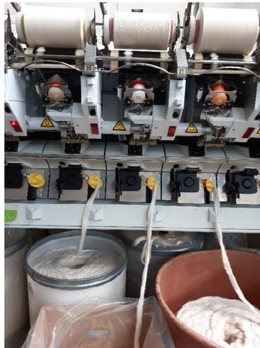
**Abbildung 2: Garnherstellung aus einem Faserband auf der Rotorspinmaschine von Oerlikon / Schlafhorst (Autocoro 480).**
