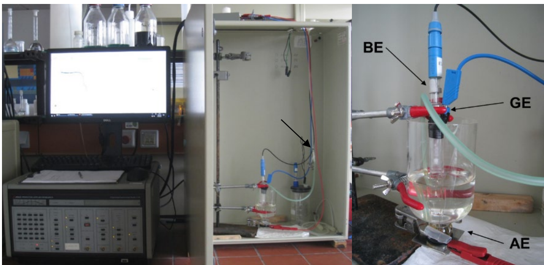
Abb. 1: Versuchsaufbau zur Messung der iU -Kurven und Potentiostatischen Halteversuche, rechts: Detailaufnahme Messzelle
