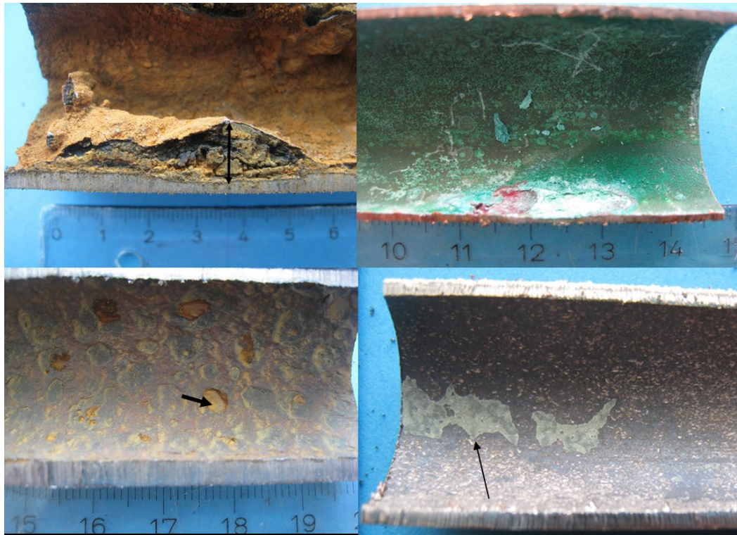
Abb. 6: Geschädigte (oben) und gestrahlte (unten) Rohrhalbschalen aus Stahl (links) und Kupfer (rechts) der Rohrrinnensanierer
