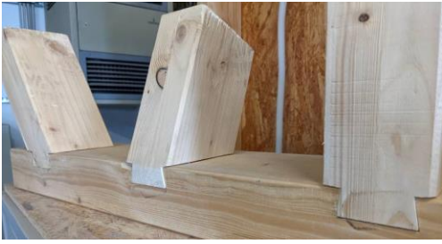
Abb.- 4-4 Schwalbenschwanzverbindung nach ABZ Z-9.1-649 (Eigene Darstellung)
