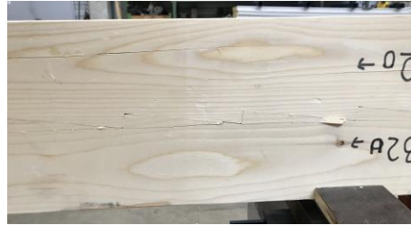
(b) Abscheren der Zähne am Auflager
