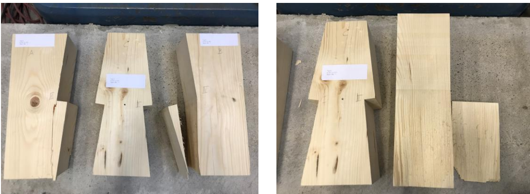
Abb.- 6-19 Versagen durch Abscheren. Bruchbild von Typ 4 Nr. 1 9
