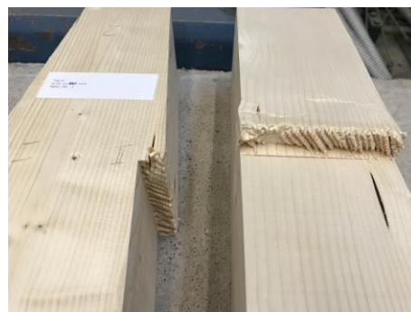
(b) Druckversagen des Zahnpaares II-IV
