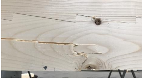
(a) Biegezugversagen bei Ast
