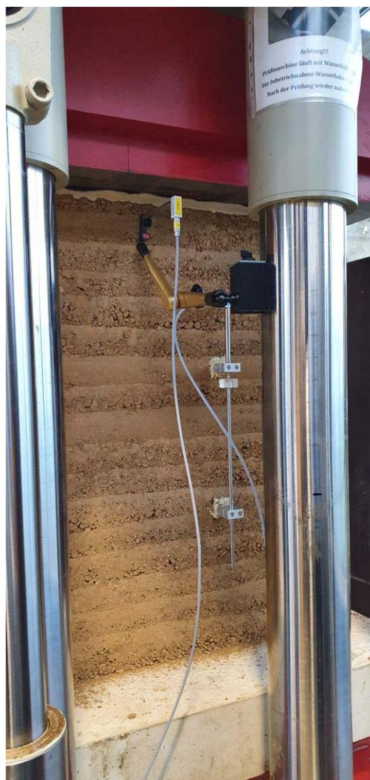
Bild A 19: Bauteilprüfkörper in der Prüfmaschine
