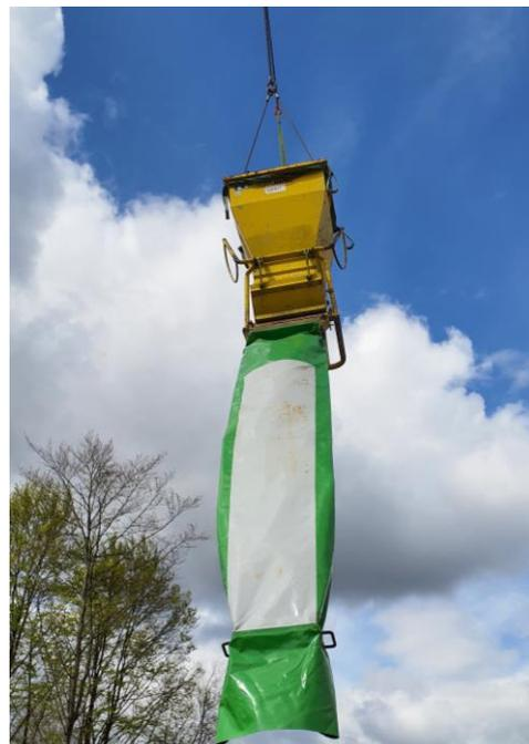
Abb. 21 (rechts): Einbringsilo mit Füllschlauch
