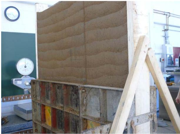
Bild A 23: Bauteilprüfkörper  $\lambda=13,33$
