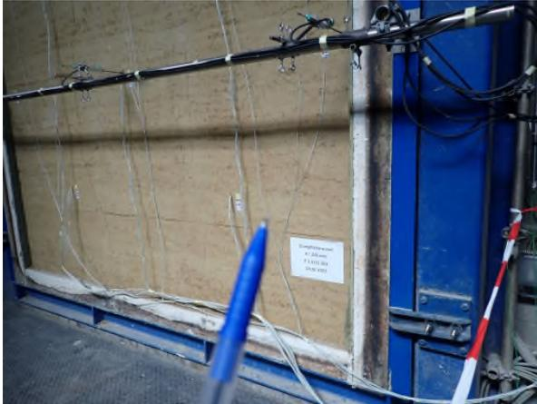
*Bild A6.7 Prüfminute 19: Auf der rechten Probekörperseite entsteht im unteren Eckbereich ein weiterer Riss.*
