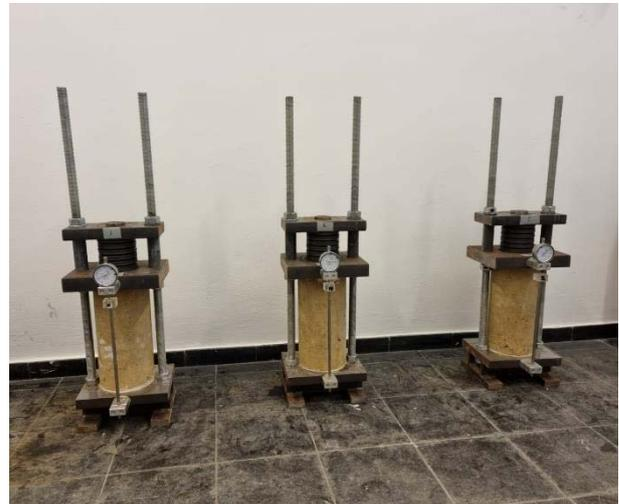
Bild A 4: Prüfstand Kriechverhalten Zylinder
