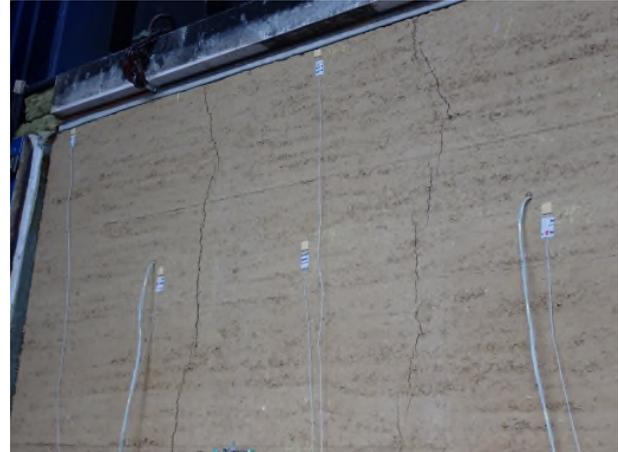
*Bild A6.8 Prüfminute 24: Rissaufweitung der beiden benannten Vertikalrisse erkennbar.*
