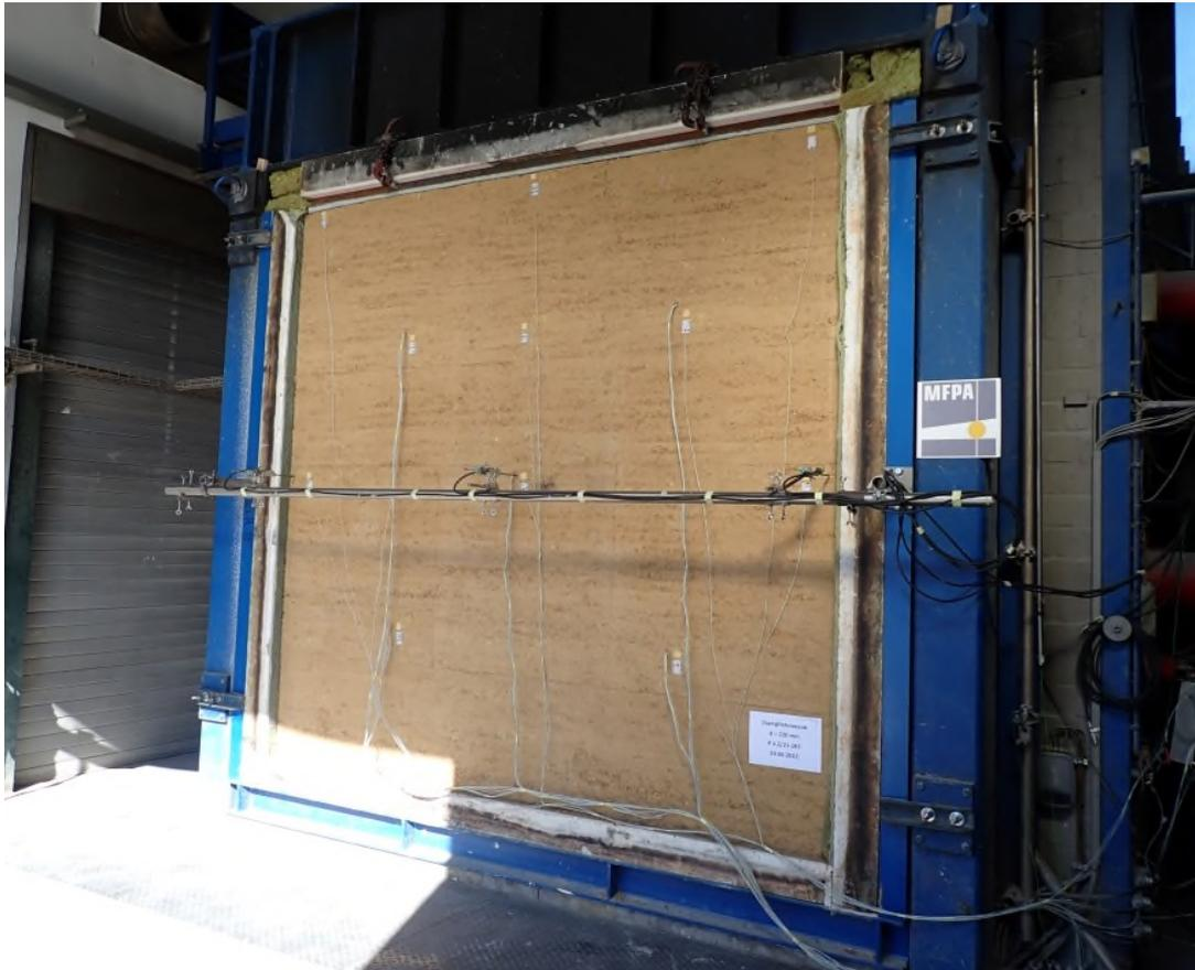
*Bild A5.7 Ansicht der feuerabgewandten Seite der Stampflehmwandkonstruktion  $d = 220$  mm.*
