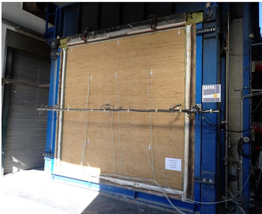
Anlage 2 Messstellenanordnung der Oberflächenthermoelemente und der eingebauten Thermoelemente in der Wandkonstruktion, sowie Lage der Wegsensoren
