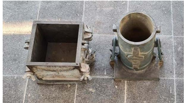
Bild A 2: Kleinprüfkörper Schalungsformen
