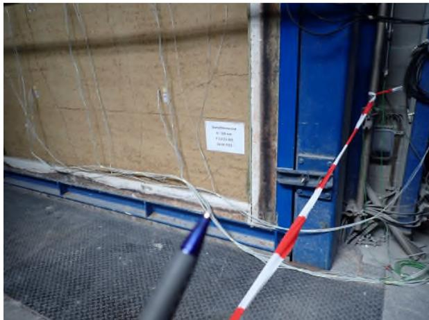
*Bild A6.12 Prüfminute 46: Auf der rechten Probekörperseite entsteht neben dem bereits existierenden Riss ein weiterer kleinerer Riss.*
