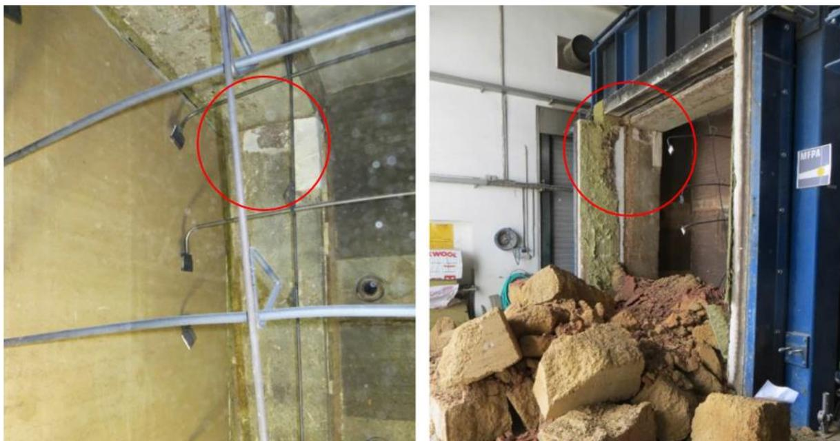
Abb. 81: Abbrand der Mineralwolle in der oberen linken Ecke nach Ablösen von ca. 10 cm tiefen Wandabschnitten
