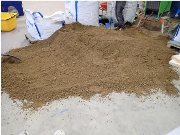
*Bild A5.1 Der Stampflehm wurde vor dem Einbau in der Prüfhalle ausgebreitet und vorgetrocknet.*
