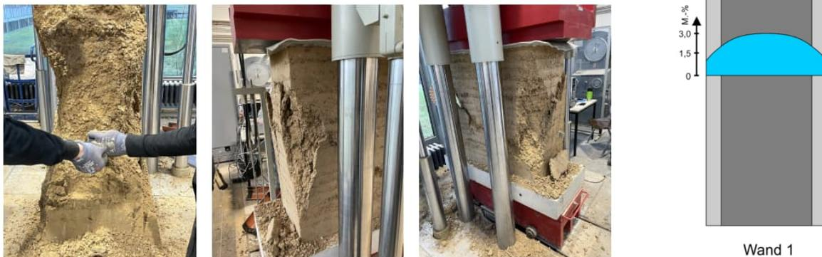
Bild 8 Geprüfte „breite Wand“ mit hoher Kernfeuchte und niedriger Festigkeit (Quelle: Wigger IfMB)
