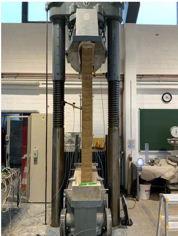
Bild A 25: Bauteilprüfkörper  $\lambda=13,33$
