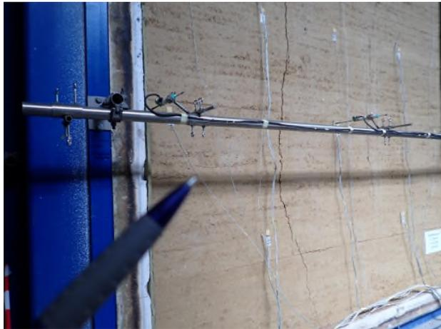
*Bild A6.10 Prüfminute 29: Auf der linken Probekörperseite entsteht ein weiterer Riss im Stampflehm.*
