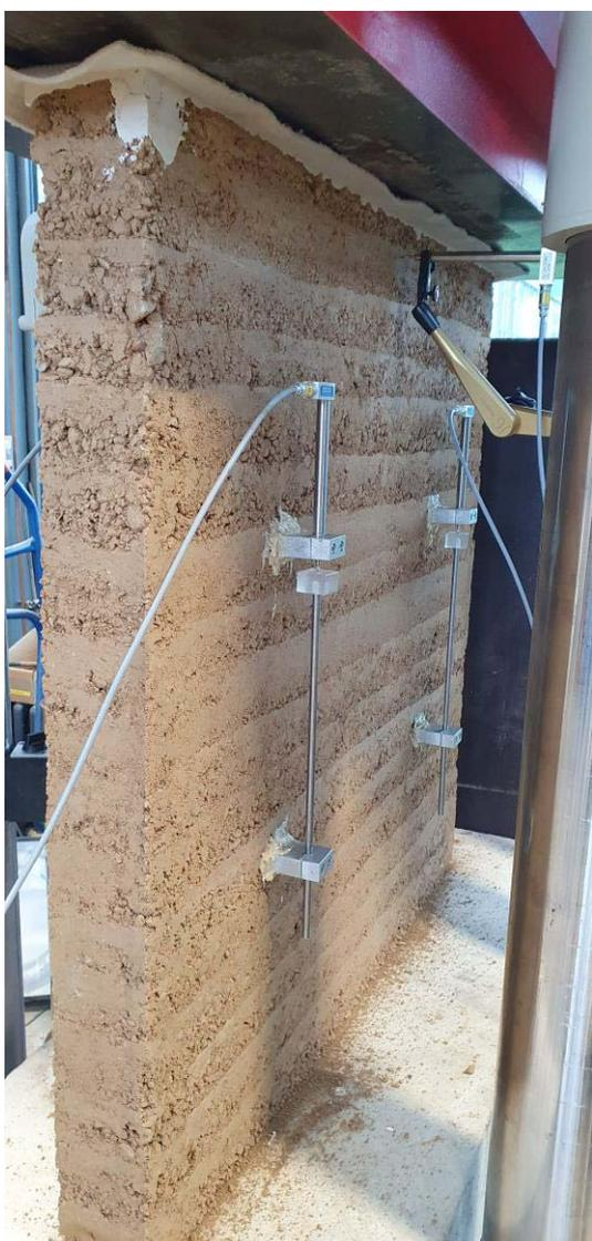
Bild A 18: Bauteilprüfkörper in der Prüfmaschine
