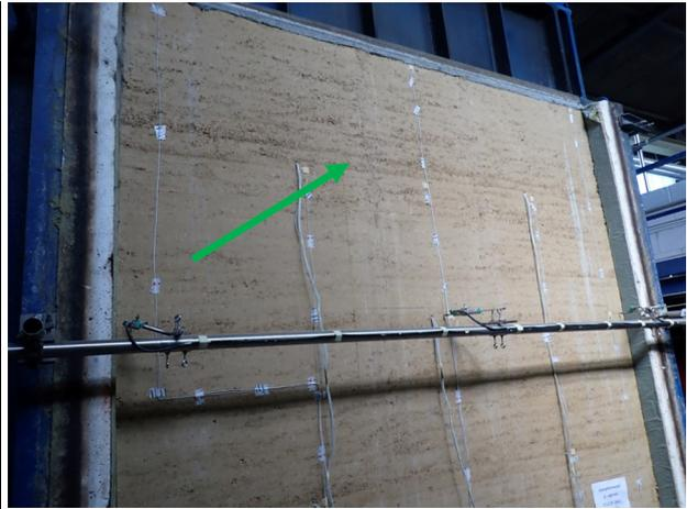
*Bild A6.14 Prüfminute 69: Darstellung des benannten Vertikalrisses in der Stampflehmoberfläche.*
