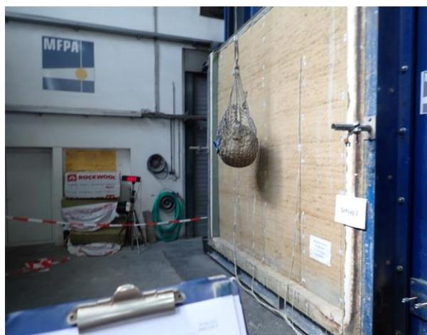
Abb. 72: Pendelschläge nach Vollendung der 90. Minute zur Ermittlung der mechanischen Beanspruchung
