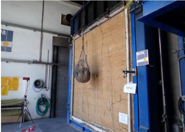
*Bild A6.19 Prüfminute 92: Ansicht des Probekörpers unmittelbar nach der ersten Stoßbeanspruchung auf der feuerabgewandten Seite.*
