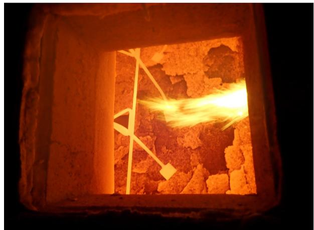
*Bild A6.22 Prüfminute 94: Ansicht des Probekörpers unmittelbar nach der zweiten Stoßbeanspruchung auf der feuerzugewandten Seite.*
