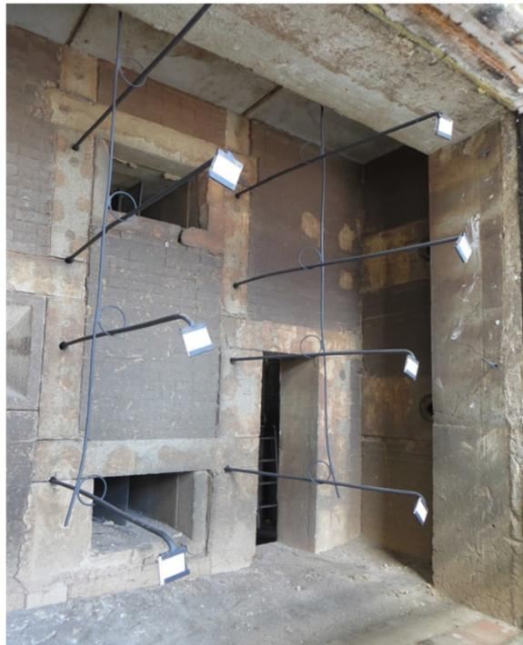
*Bild 25 Blick in die Brandkammer mit Vorrichtungen zur Befestigung der Thermoelemente für die Bestimmung der mittleren und maximalen Temperaturanstiege in der Brandkammer, MFPA Leipzig, Brandprüfstelle Laue*
