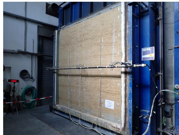
*Bild A6.18 Prüfminute 90: Ansicht des Probekörpers.*
