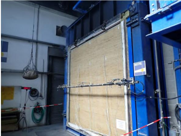
Bild A6.1 Prüfminute 1: Ansicht der Stampflehmwandkonstruktion  $d = 220$  mm.
