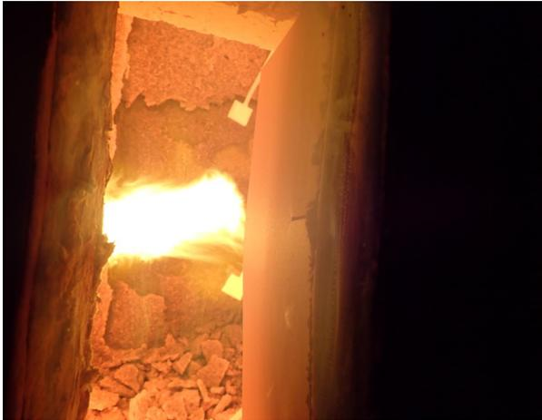
*Bild A6.13 Prüfminute 68: Weitere Bestandteile der Stampflehmwand fallen vom Probekörper ab.*
