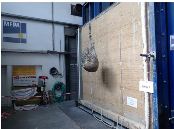
*Bild A6.23 Prüfminute 96: Ansicht des Probekörpers unmittelbar nach der dritten Stoßbeanspruchung auf der feuerabgewandten Seite.*
