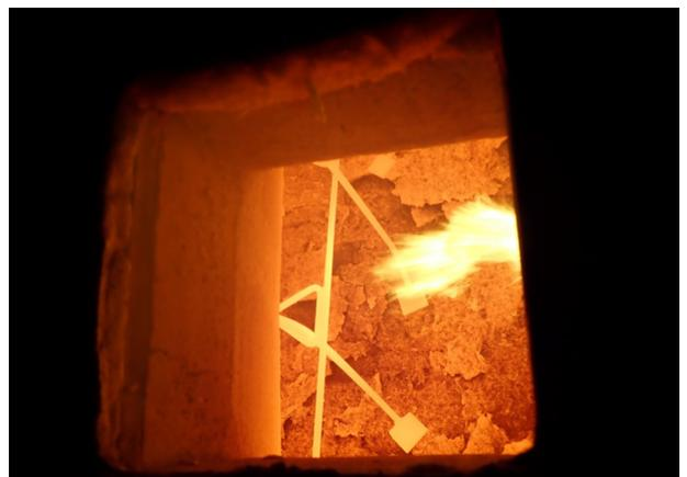
*Bild A6.24 Prüfminute 96: Ansicht des Probekörpers unmittelbar nach der dritten Stoßbeanspruchung auf der feuerzugewandten Seite.*
