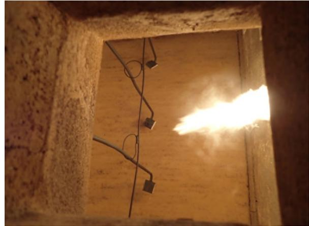
Bild A6.2 Prüfminute 1: Ansicht der Stampflehmwandkonstruktion  $d = 220$  mm feuerseitig.
