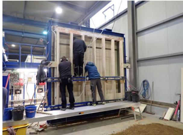
*Bild A5.2 Montage der Schalung für die Erstellung der Stampflehmwand.*
