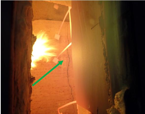
*Bild A6.7 Prüfminute 34: Vertikalriss in der vorstehenden Stampflehm-scholle erkennbar.*
