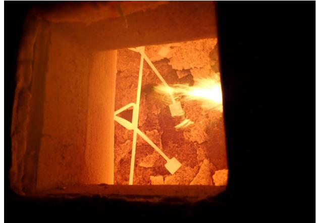
*Bild A6.20 Prüfminute 92: Ansicht des Probekörpers unmittelbar nach der ersten Stoßbeanspruchung auf der feuerzugewandten Seite.*
