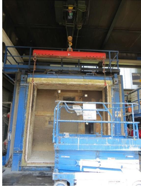
*Bild 24 Belastungsrahmen der Brandkammer für Prüfung tragender Wände nach DIN EN 1365-1 in der MFPA Leipzig, Brandprüfstelle Laue*
