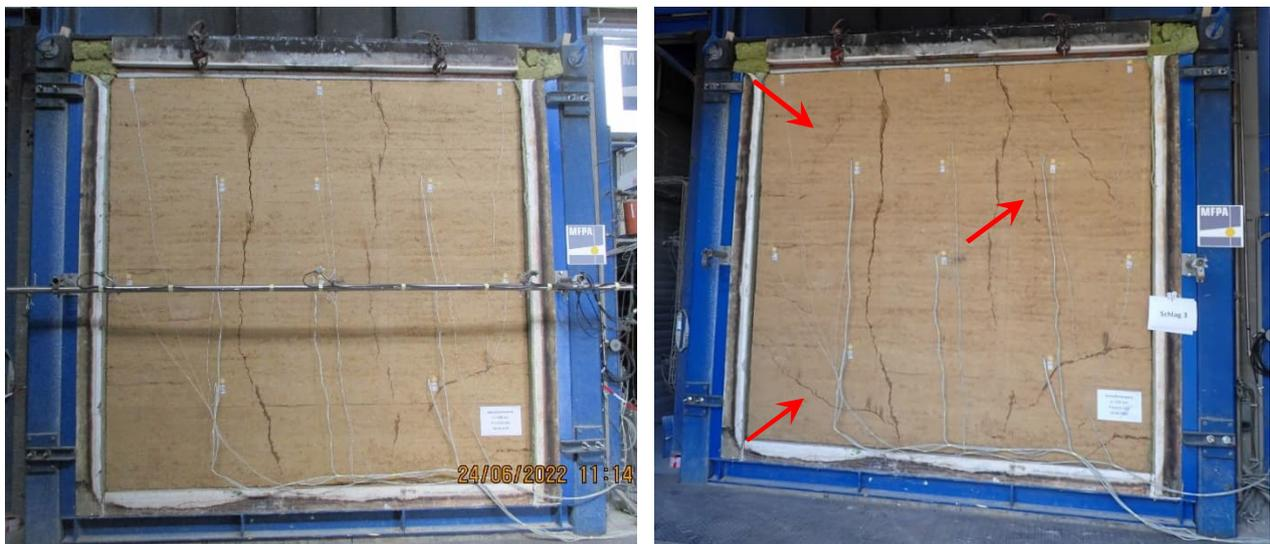
Bild 31 Rissbild der 22 cm dicken Stampflehmwand auf der Außenseite nach 90 Minuten Brandbeanspruchung und vor dem 1. Pendelschlag (links) und nach dem 3. Pendelschlagversuch (rechts)
