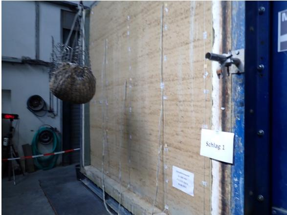
*Bild A6.19 Prüfminute 92: Ansicht des Probekörpers unmittelbar nach der ersten Stoßbeanspruchung auf der feuerabgewandten Seite.*
