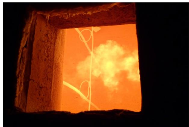
*Bild A6.24 Prüfminute 96: Ansicht des Probekörpers unmittelbar nach der dritten Stoßbeanspruchung auf der feuerzugewandten Seite.*
