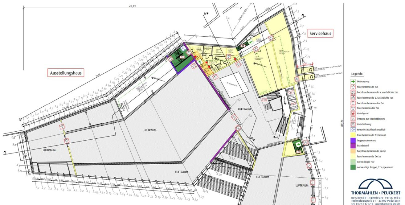
Bild 3 Grundriss Eingangs-, Service- und Ausstellungshaus im EG mit brandschutztechnischen Anforderungen an die Lehmwände, speziell die Trennwand in Achse 3.8 einschließlich der Anforderungen an die darin befindlichen Türen nach [1]
