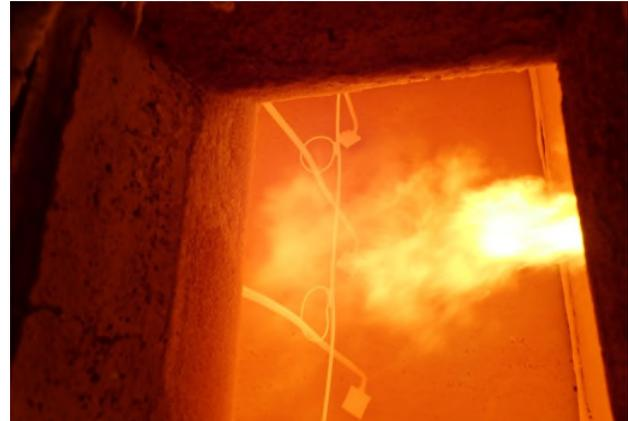
*Bild A6.20 Prüfminute 92: Ansicht des Probekörpers unmittelbar nach der ersten Stoßbeanspruchung auf der feuerzugewandten Seite.*
