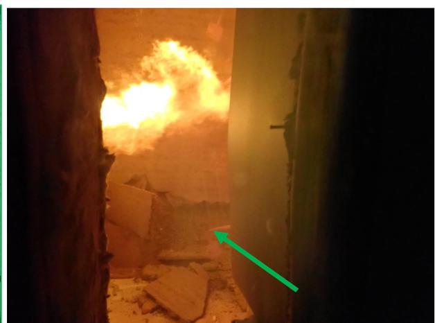
Bild A6.4 Prüfminute 27: Im unteren Bereich staucht die Stampflehmwandoberfläche zusammen.
