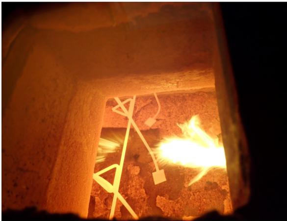
*Bild A6.15 Prüfminute 74: Ansicht der zerklüfteten Oberfläche der Stampflehmwand.*
