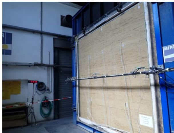
Bild A6.6 Prüfminute 17: Ansicht der Stampflehmwandkonstruktion.
