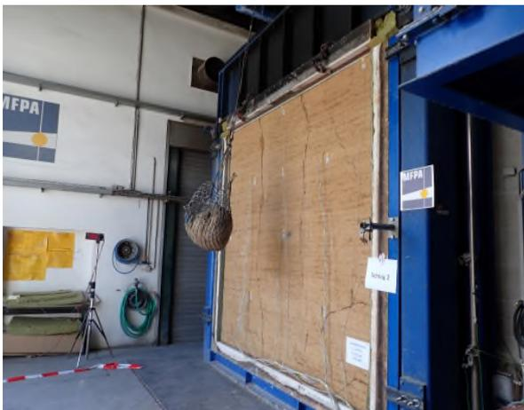
*Bild A6.21 Prüfminute 94: Ansicht des Probekörpers unmittelbar nach der zweiten Stoßbeanspruchung auf der feuerabgewandten Seite.*
