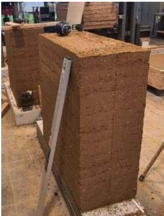
Bild A 9: Bauteilprüfkörper ( $\lambda = 2,5$ ) nach Herstellung
