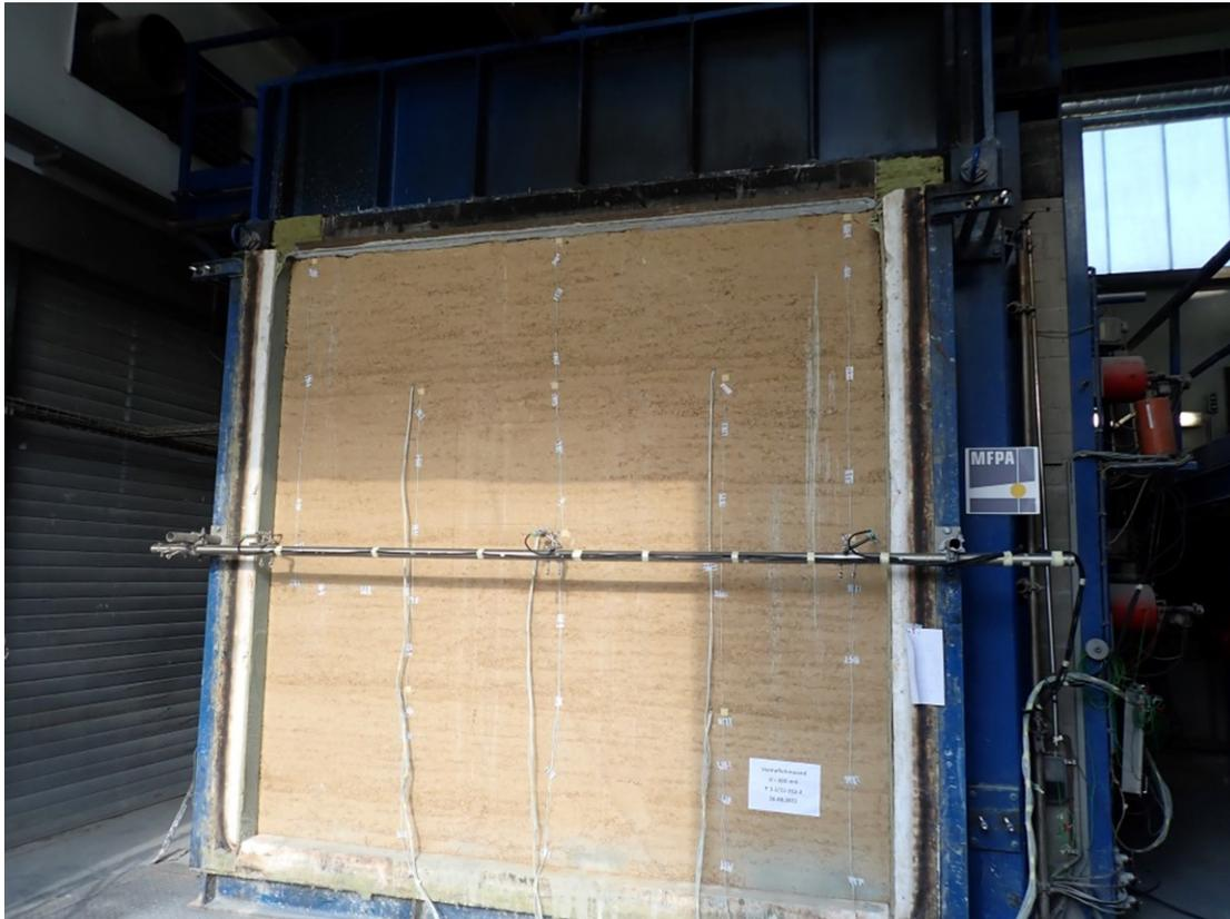
*Bild A5.7 Ansicht der feuerabgewandten Seite der Stampflehmwandkonstruktion  $d = 600$  mm.*
