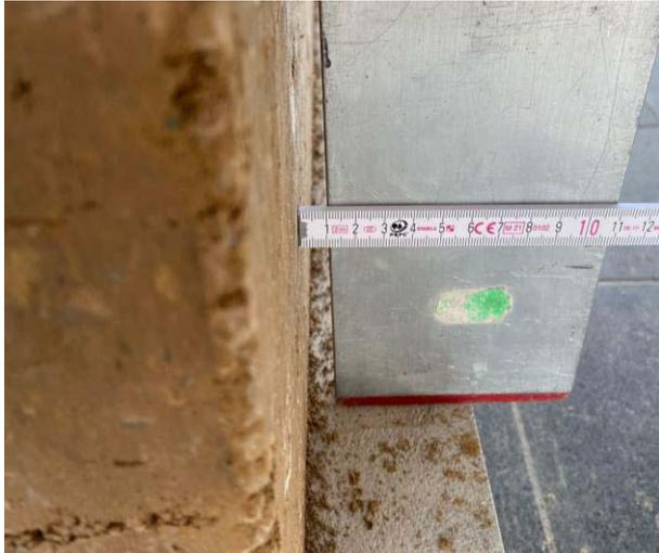
Bild A 7: Schiefstellung des Prüfkörpers mit Holzschalung
