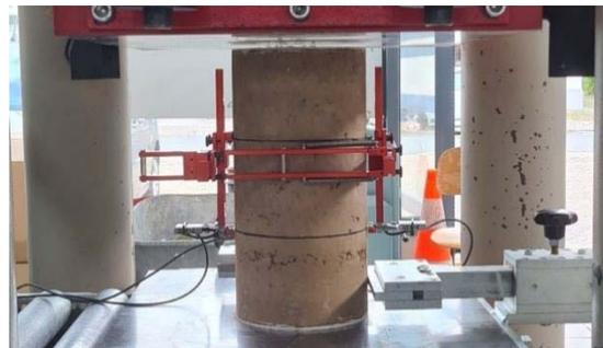
Bild A 6: Versuchsaufbau E-Modulprüfung
