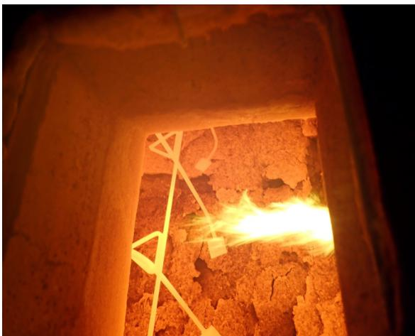
*Bild A6.17 Prüfminute 86: Ansicht der zerklüfteten Oberfläche der Stampflehmwand.*
