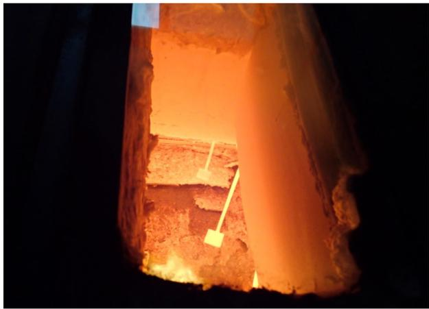
*Bild A6.16 Prüfminute 79: Weitere Bestandteile der Stampflehmwand fallen vom Probekörper ab.*
