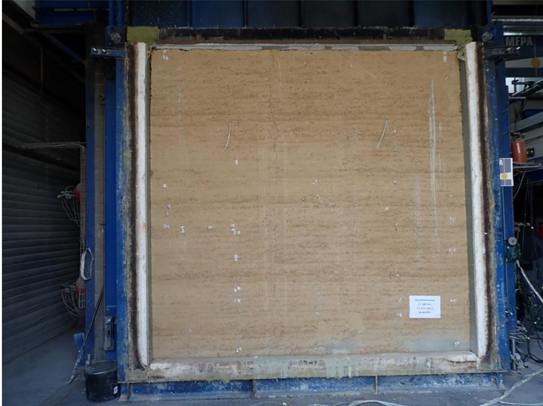
*Bild A6.25 Ansicht der Stampflehmwandkonstruktion nach Beendigung der Feuerwiderstandsprüfung.*
