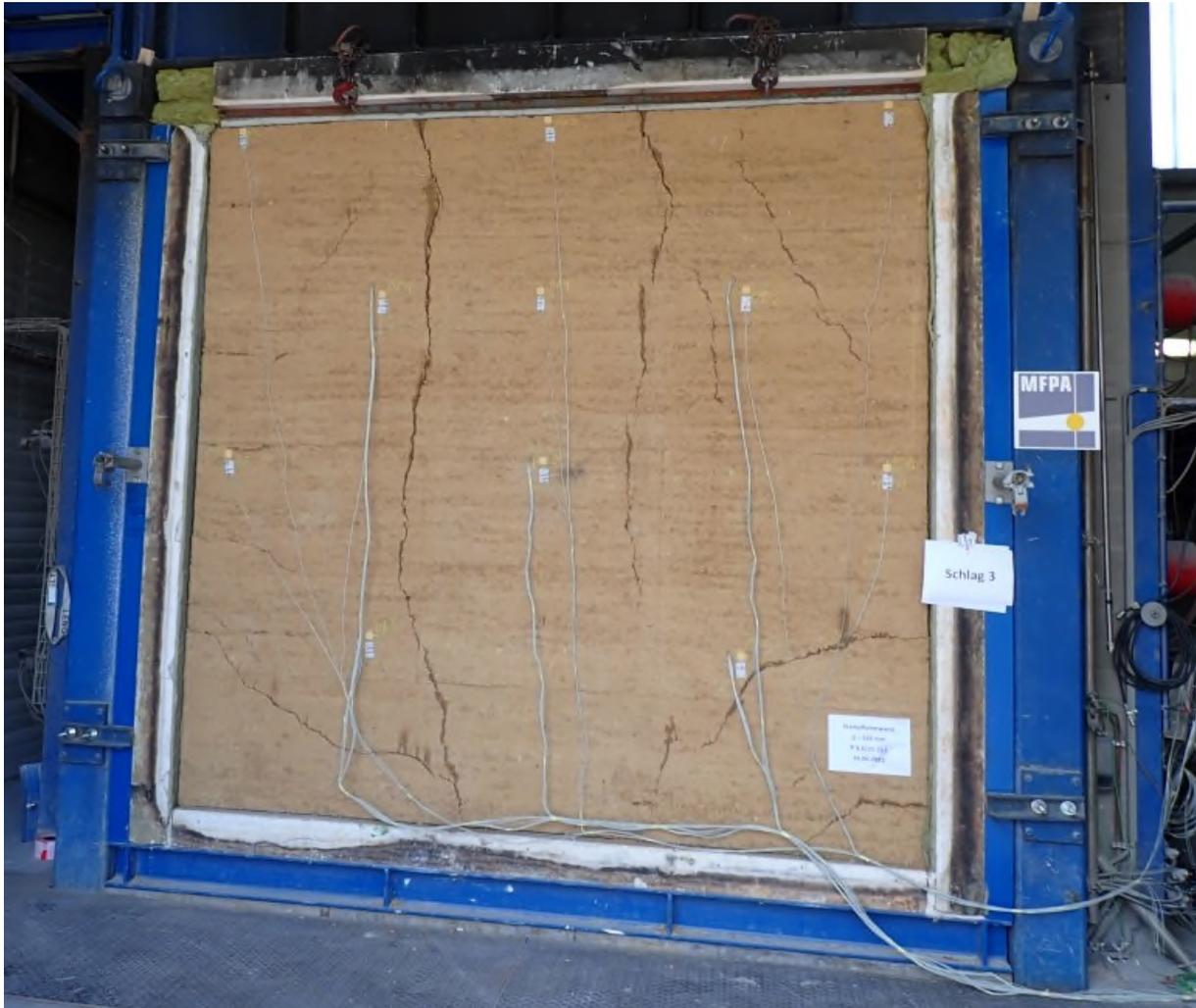
*Bild A6.25 Ansicht der Stampflehmwandkonstruktion nach Beendigung der Feuerwiderstandsprüfung*
