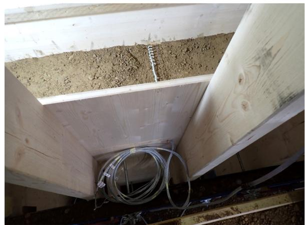
*Bild A5.4 Positionierung der Messleiter zur Ermittlung der Temperaturen im Probekörperquerschnitt.*
