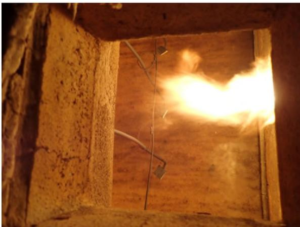
Bild A6.3 Prüfminute 7: Verfärbungen auf der Probekörperoberfläche zu erkennen.
