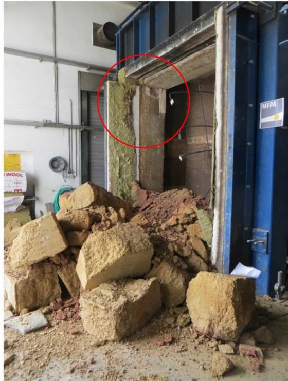
Bild 35 Blick in die Brandkammer vor und nach dem Versuch mit speziellem Blick auf die mit Wärmedämmung ausgefüllte Vertikalfuge am linken Rahmenstiel
