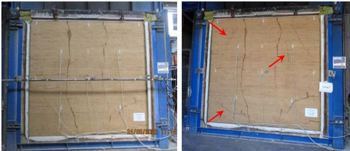
Abb. 78: Rissbild der Stampflehmwand (d = 220 mm) auf der brandabgewandten Seite nach 90 Minuten Brandbeanspruchung vor dem 1. Pendelschlag (links) und nach dem 3. Pendelschlag (rechts)
