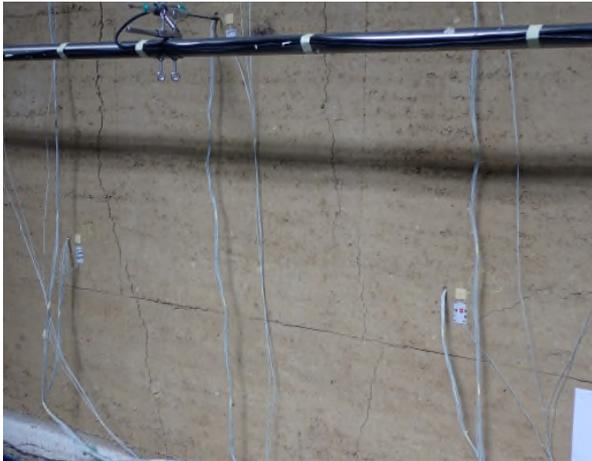
*Bild A6.9 Prüfminute 25: Rissaufweitung der beiden benannten Vertikalrisse erkennbar.*
