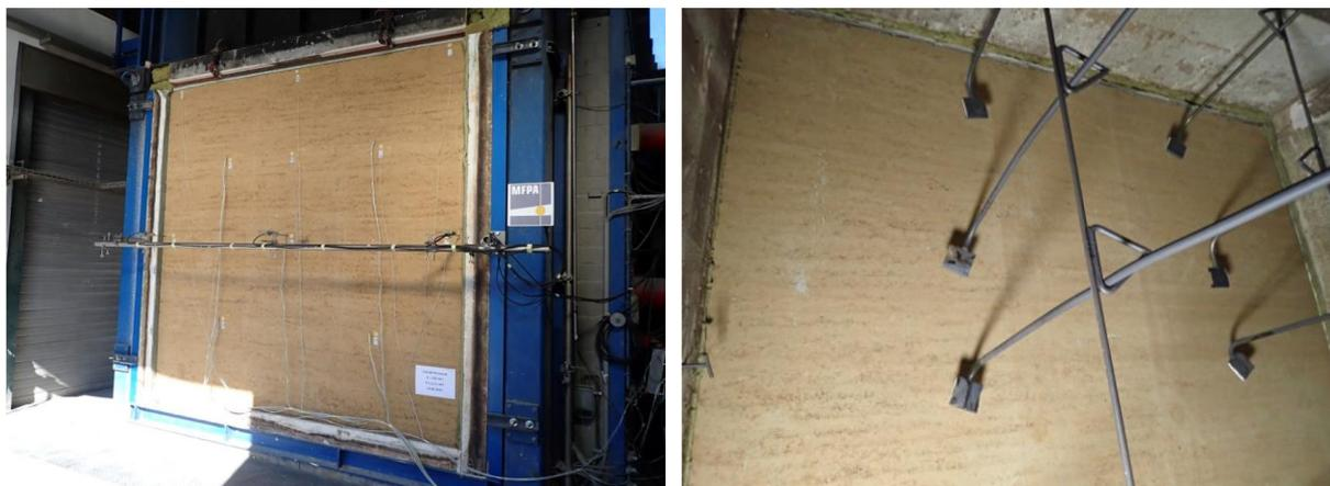
Abb. 70 (links): Ansicht der feuerabgewandten Seite der Stampflehmwandkonstruktion  $d = 220$  mm
