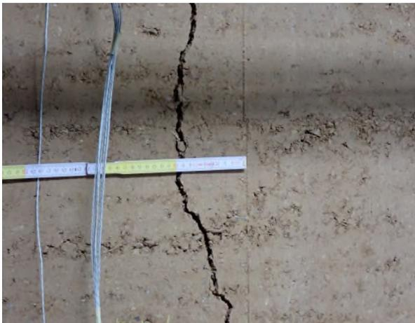
*Bild A6.11 Prüfminute 41: Zunehmende Rissaufweitung der beiden vertikalen Hauptrisse, Rissbreite am linken Riss ca. 8,0 mm*
