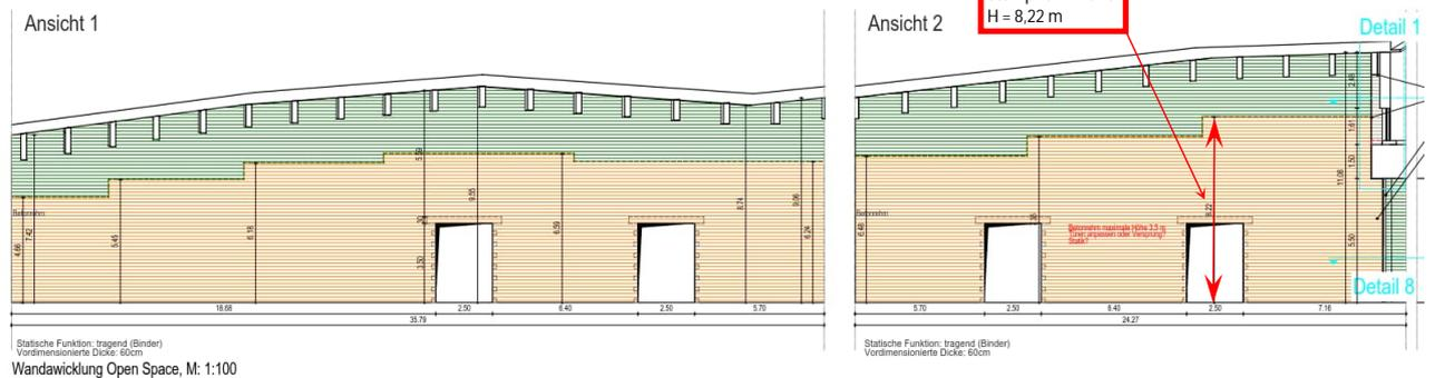
**Bild 6** Wandabwicklungen der beiden tragenden Lehmwände aus Bild 4 (nach [7])
