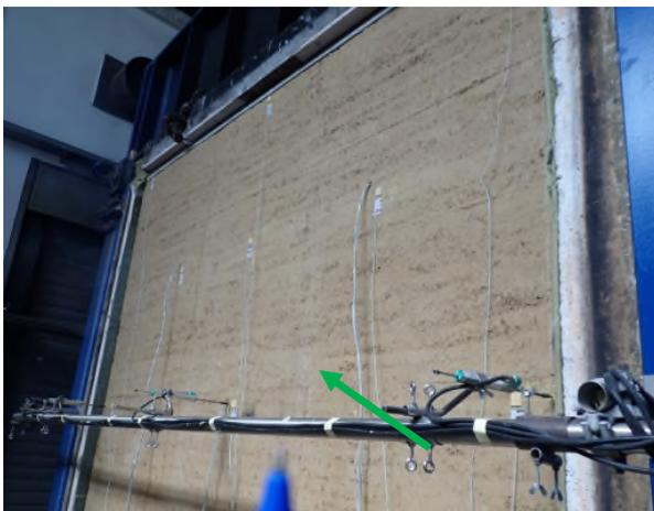
Bild A6.5 Prüfminute 15: Ein weiterer Vertikalriss entsteht auf der rechten Probekörperseite.
