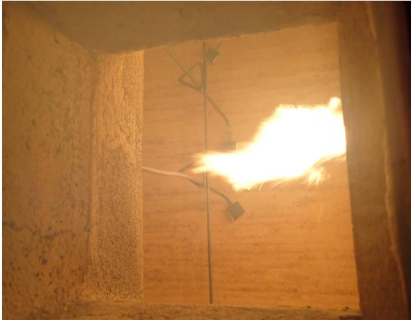
Bild A6.1 Prüfminute 1: Ansicht der Stampflehmwandkonstruktion  $d = 600$  mm.
