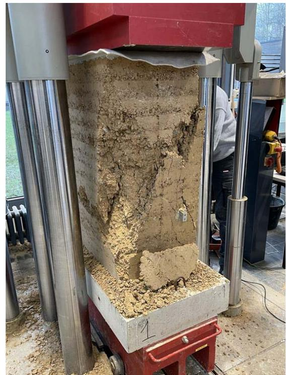
Bild A 10: Bauteilprüfkörper ( $\lambda = 2,5$ ) Wand 2 nach der Prüfung
