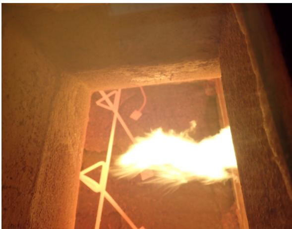
*Bild A6.11 Prüfminute 60: Weitere Bestandteile der Stampflehmwand fallen vom Probekörper ab.*
