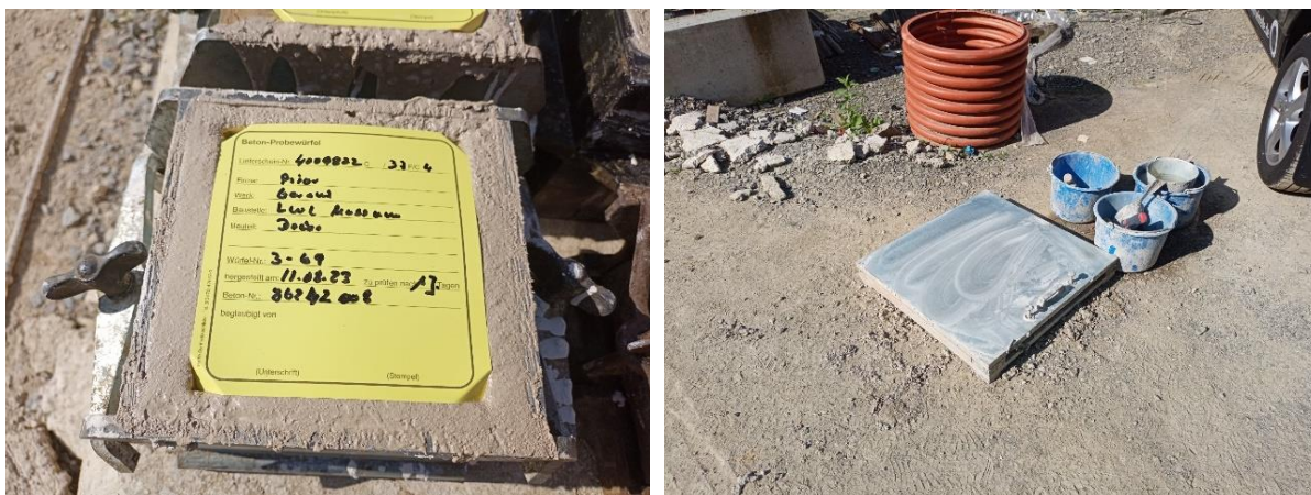
Abbildung 29 Prüfkörper zur Güteüberwachung und Rüttelplatte zur Bestimmung des Ausbreitmaßes
