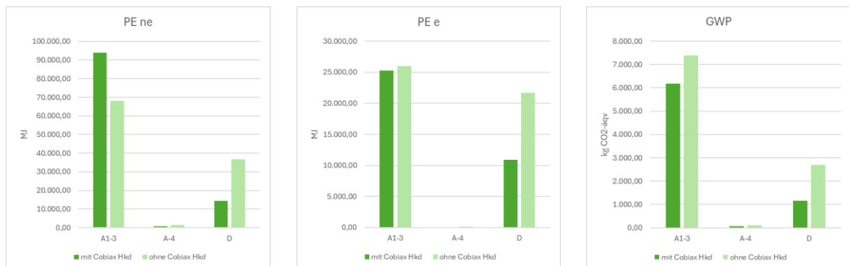
Abbildung 10 Vergleich des Ökobetones mit und ohne Hohlkörpereinsatz
