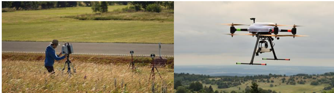
Abbildung 14: Links: Terrestrischer Laserscanner, rechts: Trägerplattform mit Hyperspektralkamera.
