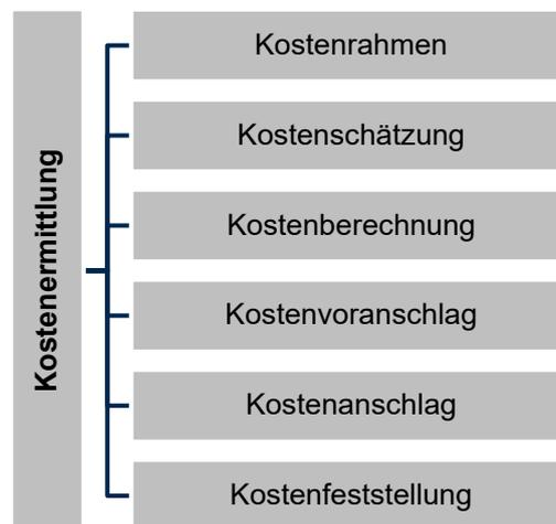
Abb. 4: Kostenermittlungsstufen nach DIN 276
