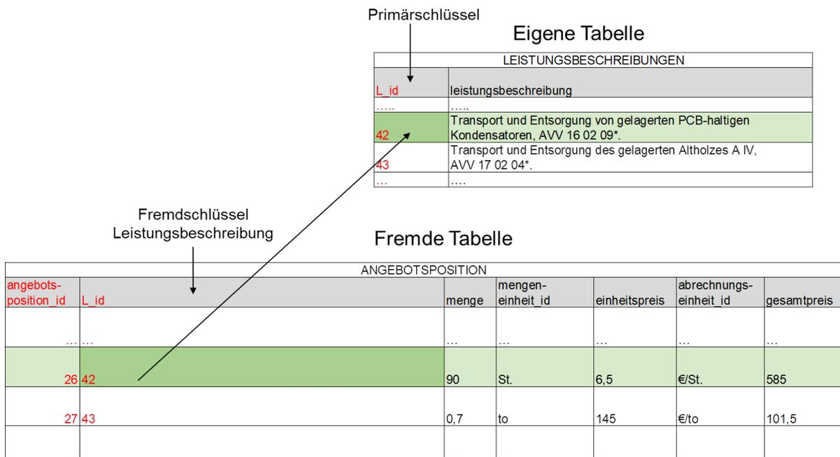
Abb. 18: Primärschlüssel – Fremdschlüssel
