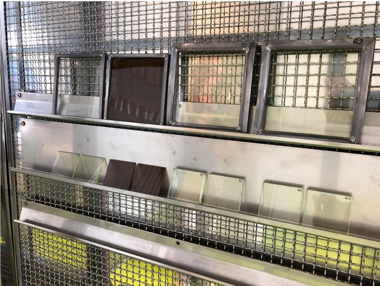
Abb. 9: Glasproben im Klimaschrank UV200; 1. Bewitterung 11.09.18- 06.12.2018
